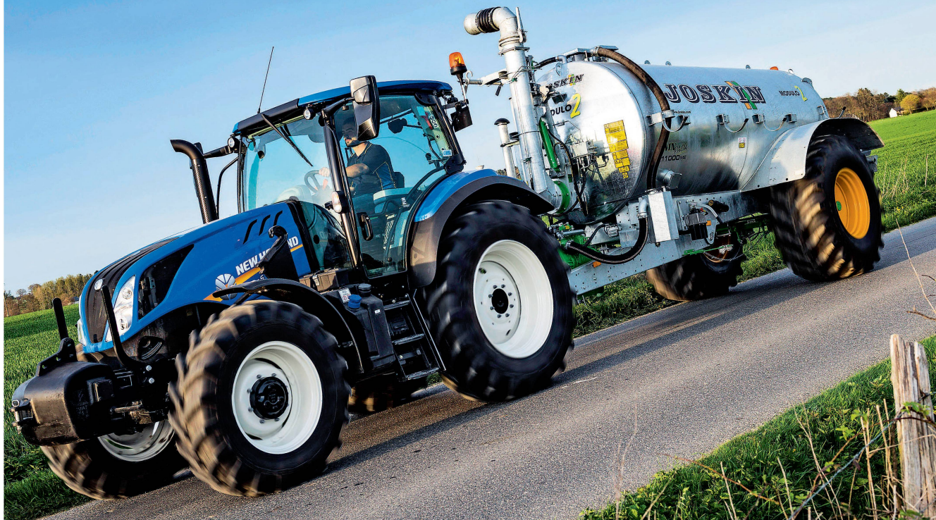
Der Fahrer kann das Verhalten seines Traktors mit einem stufenlosen Getriebe im Schubbetrieb auf verschiedene Weisen beeinflussen.
