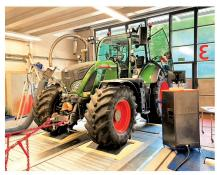
Die Bremskraft und der Rollwiderstand wurden auf einem Rollenprüfstand gemessen. Bild: J. Pochon
