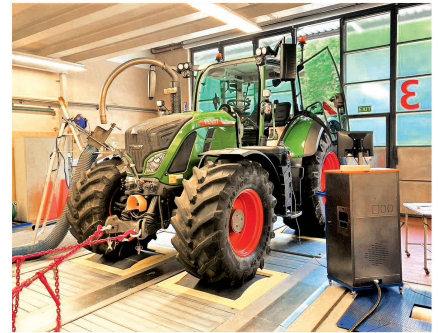
Die Bremskraft und der Rollwiderstand wurden auf einem Rollenprüfstand gemessen. Bild: J. Pochon
