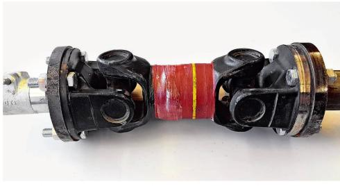
Um die äquivalenten Motorschleppmomente der getesteten Traktoren zu bestimmen, wurde ein Drehmomentsensor an der Heckzapfwelle installiert. Bild: J. Pochon
