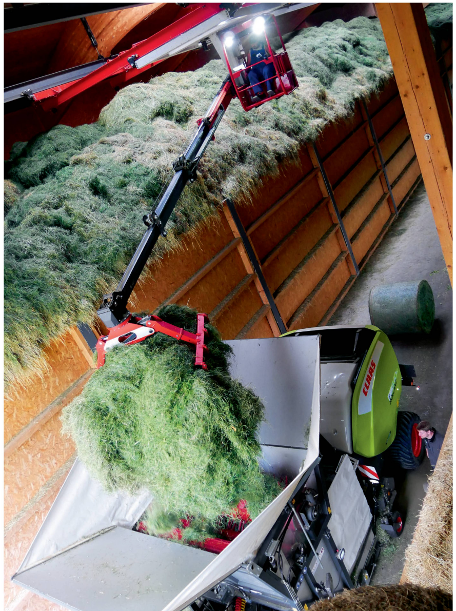
Das Dosiergerät wird über einen aufgeklappten Trichter mit Hilfe einer Krananlage oder eines Teleskopladers befüllt.
