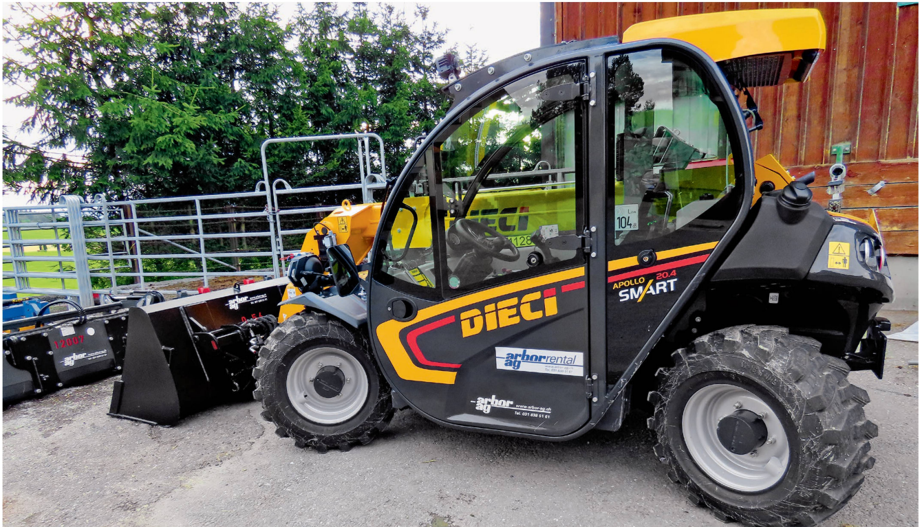
Für den Güterumschlag und bei alltäglichen Hofarbeiten geeignet: der Dieci «Mini Agri 20.4 Smart», er stapelt bei hoher Wendigkeit bis auf eine Höhe von 4,35 m. Bilder: M. Abderhalden
