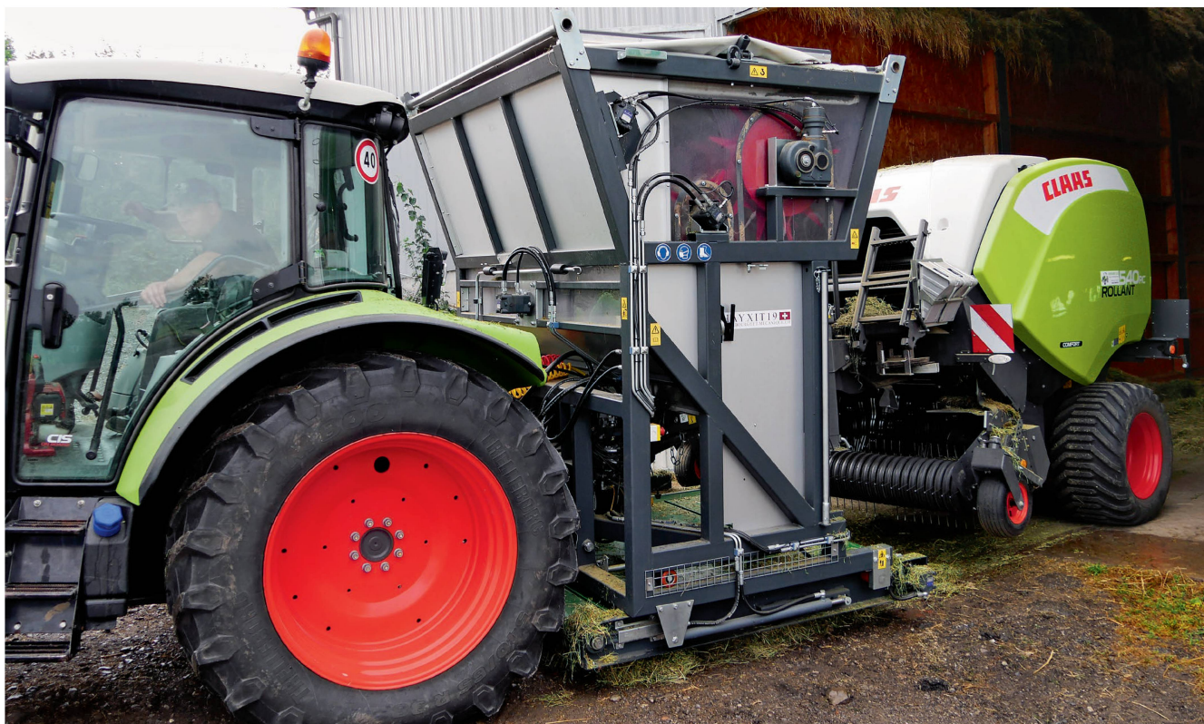
Der Heudosierer «Hayxit 19» der Firma Bourguet Mécanique SA hier im Einsatz mit einem Claas «Arion 500» und einer «Rollant 540 RC». Das Dosiergerät wird an die Dreipunkthydraulik des Traktors gekoppelt. Bilder: Matthieu Schubnel
