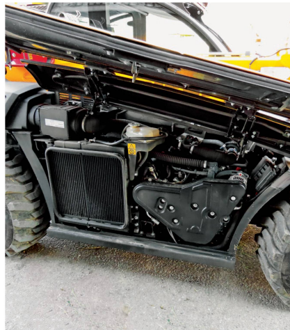
Der Kubota-Motor ist quer eingebaut, die Seitenklappe sorgt für eine gute Zugänglichkeit zu den Wartungspunkten.
