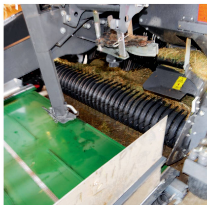
Das aufgelockerte Futter fällt auf ein PVC-Rollband, das die Pick-up der Presse gleichmässig mit Heu beschickt. Das verhindert Verstopfungen.
