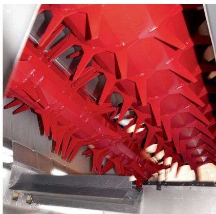
Zwei hydraulisch angetriebene Dosierwalzen mit unterschiedlichen Durchmesser und Umlaufgeschwindigkeiten reissen das Heu schonend auseinander.
