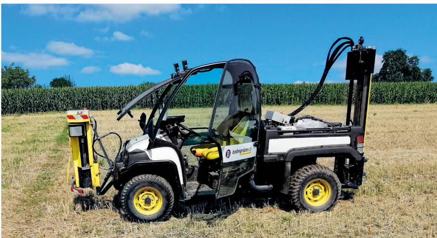
Die Beprobung an immer denselben Einstichpunkten ist wichtig, selbst auf eher kleinen Parzellen. Pro Parzelle müssen 20 Einstiche durchgeführt werden.
