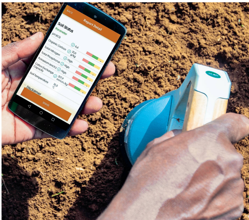
Wenige Sekunden nach der Messung auf Knopfdruck mit dem Sensorspaten werden die Bodenparameter punktgenau beispielsweise auf einem Tablet angezeigt. Bild: Stenon GmbH
