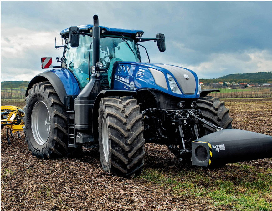
Oben: Verdichtungen aufspüren und das Bearbeitungsgerät entsprechend steuern ist nur eine Möglichkeit, den Bodenscanner zu nutzen. Bild: Geoprospectors
