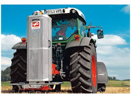
Das mechanische Stechen mit einem Entnahmegerät erhöht die Attraktivität und die Genauigkeit der Bodenproben. Bild: Fritzmeier
