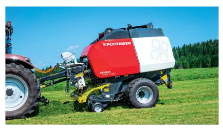
Die neue «Impress»-Generation hat mehr Pressdruck und eine komplett neu entwickelte Bindeeinheit erhalten. Überarbeitet wurde auch das Design. Bilder: zvg
