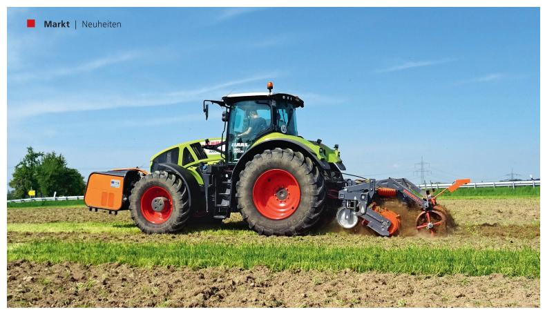
«Rotapull» im Einsatz mit Stromgenerator im Front- und dem eigentlichen Bodenbearbeitungsgerät im Heckanbau. Bilder: D. Senn
