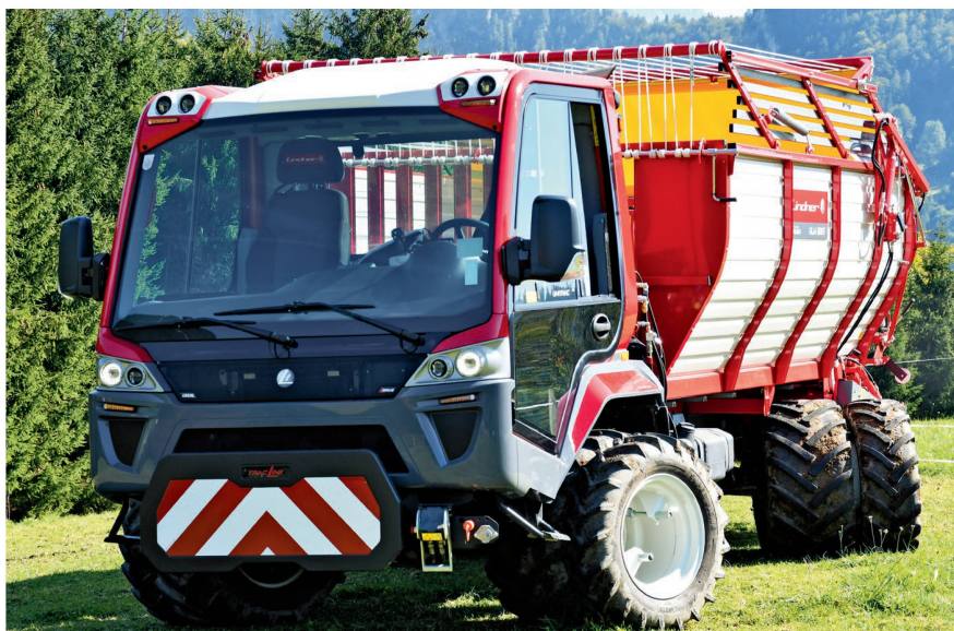
Der «Unitrac 122 LDrive» mit dem neuen Gruber-Ladewagen und mit 4-Rad-Lenkung ist äusserst wendig. Bild: R. Hunger
