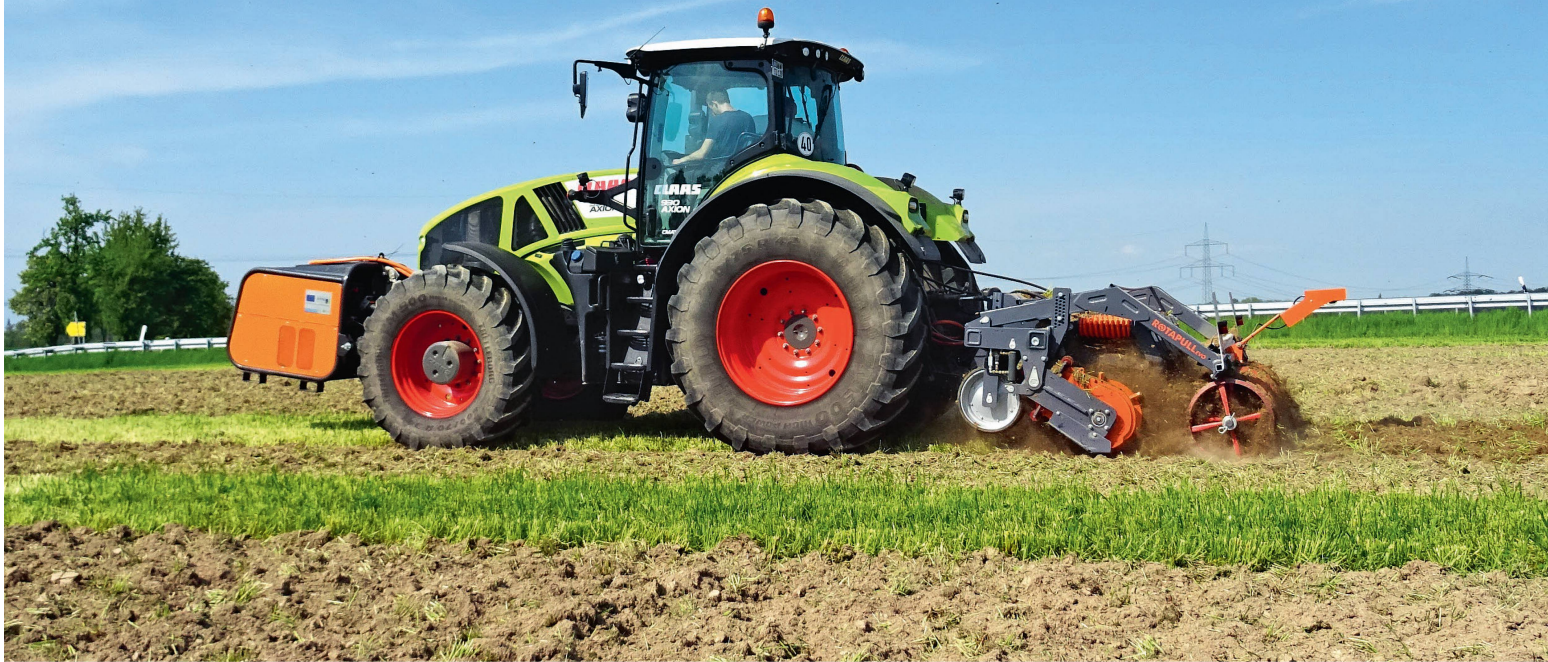
«Rotapull» im Einsatz mit Stromgenerator im Front- und dem eigentlichen Bodenbearbeitungsgerät im Heckanbau. Bilder: D. Senn
