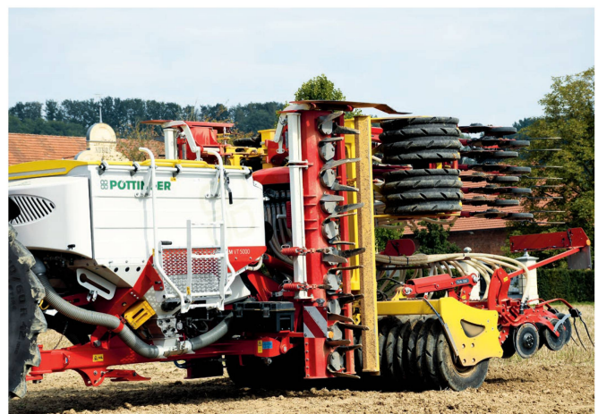
Weg von hohen Achslasten: Die klappbare 5-Meter-«Aerosem VT» mit Kreiselegge der Serie «Lion 103 C». Bilder: R. Hunger
