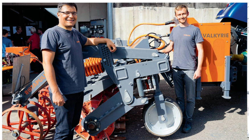
Kronos-Geschäftsführer Tim Bögel (zwischen Nachläufer und Rotor) und Start-up-Teilhaber Marvin Elz (vor dem Generator) beim Prototyp des «Rotapull EVO»: Der Rotorbereich wird zwecks Schutz vor herumfliegender Erde/Steine im Einsatz mit einer Plane abgedeckt.
