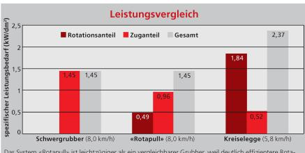
Das System «Rotapull» ist leichtzügiger als ein vergleichbarer Grubber, weil deutlich effizientere Rotationsleistung vom Diesel und weniger verlustbehaftete Zugkraft über Rad-Boden-Kontakt genutzt wird.
