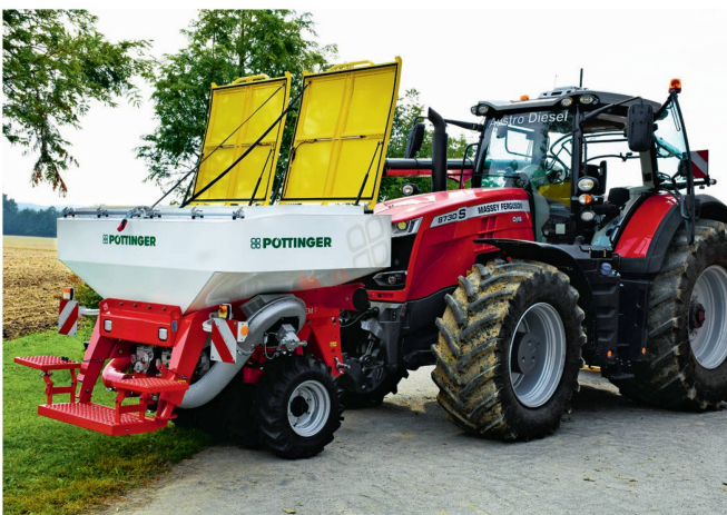
Den Fronttank zur «Aerosem 6002 FDD» hat Pöttinger neu entwickelt. Wahlweise gibt es ein Tankvolumen von 1700 oder 2400 Liter.
