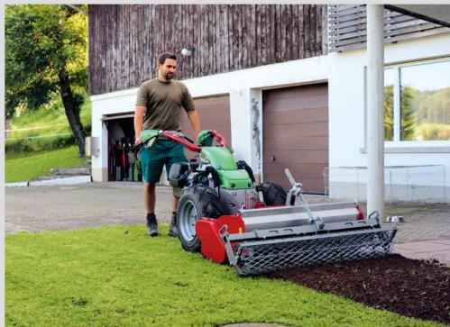
Die entgegen der Fahrtrichtung rotierenden Zinkenpaare fräsen den Boden fein auf. Altrasen, Pflanzenreste und Steine werden gegen einen Rechen geschleudert und nach unten in den Boden eingearbeitet. Gleichzeitig wird das fein gefräste Erdgut an der Oberfläche abgelegt.
