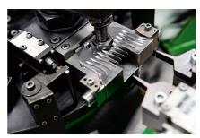
Das Fräsen und Schleifen der Kämme und Cutter besorgen Roboterarme.
