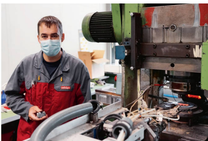
Die Schaf-Obermesser werden aus gestanzten Teilen einzeln durchlauferhitzt und geschmiedet.
