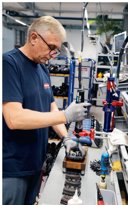
In Montagestrassen erfolgt der Zusammenbau, hier der Ober- und Untermesser.
