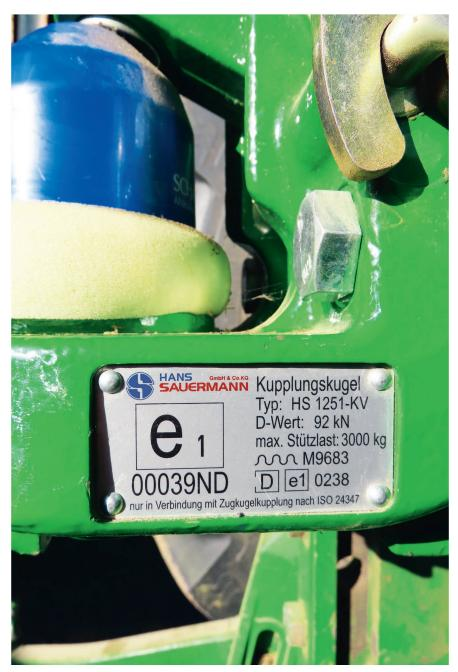
Der D-Wert ist im Typenschild der Anhängerkupplung eingeprägt. In diesem Fall hat der Anhaubock einen D-Wert von 92 kN, Bild: M. Abderhalden
