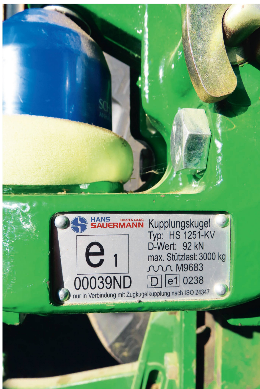
Der D-Wert ist im Typenschild der Anhängerkupplung eingepreßt. In diesem Fall hat der Anbaubock einen D-Wert von 92 kN. Bild: M. Abderhalden
