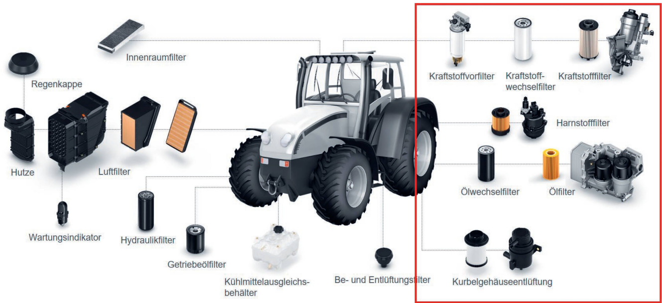
Während alle Kraftstoff- und Ölfilter (Rahmen) bei einem Brennstoffzellen-Antrieb entfallen, braucht es neue Kathodenluftfilter.
