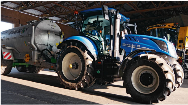
Der «T6.180 Methane Power» (hier ohne Zusatztanks im Frontanbau) weist laut Hersteller eine Leistung auf, die dem gleichen Modell mit Dieselantrieb entspricht. Bild: M. Schubnel
