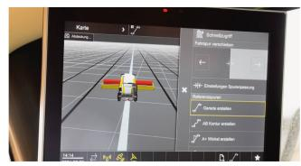
In der neuen Kabine findet man mit dem «Cemis 1200» einen zweiten Bildschirm, den man für die GPS-Navigation und die Dokumentation der Aufträge verwenden kann.
