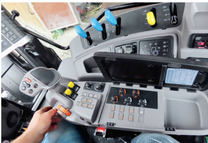
Die Kabine wirkt hell und aufgeräumt. Auf der verstellbaren Armlehne sind alle wichtigen Bedienelemente untergebracht.
