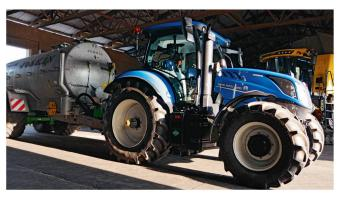
Der «T6.180 Methane Power» (hier ohne Zusatztanks im Frontanbau) weist laut Hersteller eine Leistung auf, die dem gleichen Modell mit Dieselantrieb entspricht. Bild: M. Schubnel
