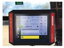
«Touch800»-Isobus-Terminal: Mit der Markteinführung der «Versa» setzt Horsch auch ein neues Bedienkonzept um.
