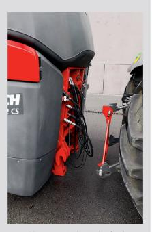
angeschlossen sowie die Stecker für das Licht und für die Isobus-Verbindung gekoppelt. Diese Vorgänge können getätigt werden, wenn sich die Spritze rund 1,5 m vom Traktor entfernt befindet. Dann wird der Traktor zum Gerät bewegt, dieses mithilfe einer Libelle am Einspülzentrum genau ausgerichtet.
