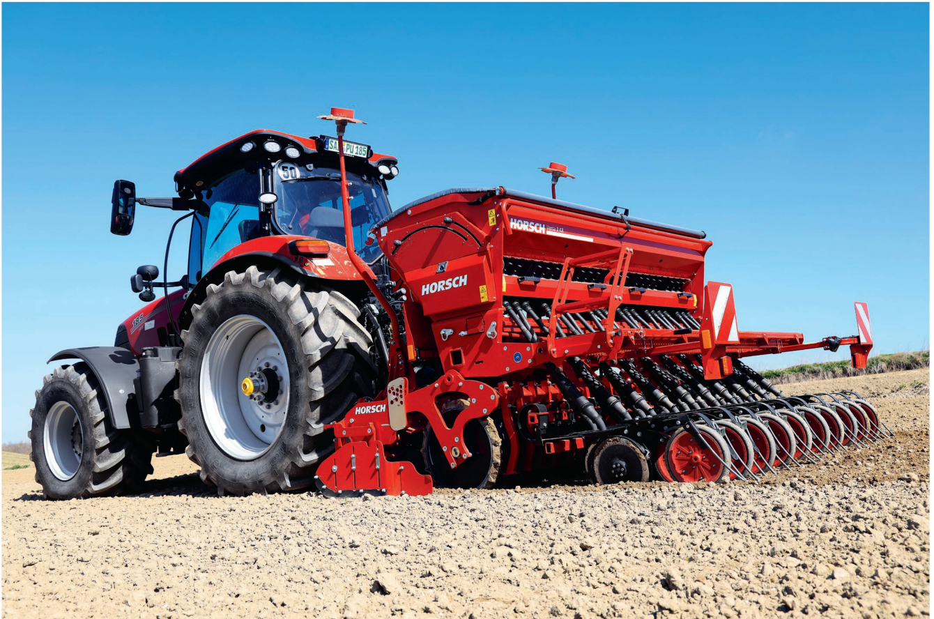
Die erste mechanische Drillmaschine von Horsch hat einen elektrischen Dosierwellenantrieb. Erhältlich ist sie mit 20 oder 24 Säscharen bzw. einem Strichabstand von 15 oder 12,5 cm. Bilder: Johannes Paar
