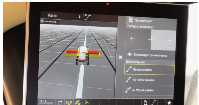
In der neuen Kabine findet man mit dem «Cemis 1200» einen zweiten Bildschirm, den man für die GPS-Navigation und die Dokumentation der Aufträge verwenden kann.
