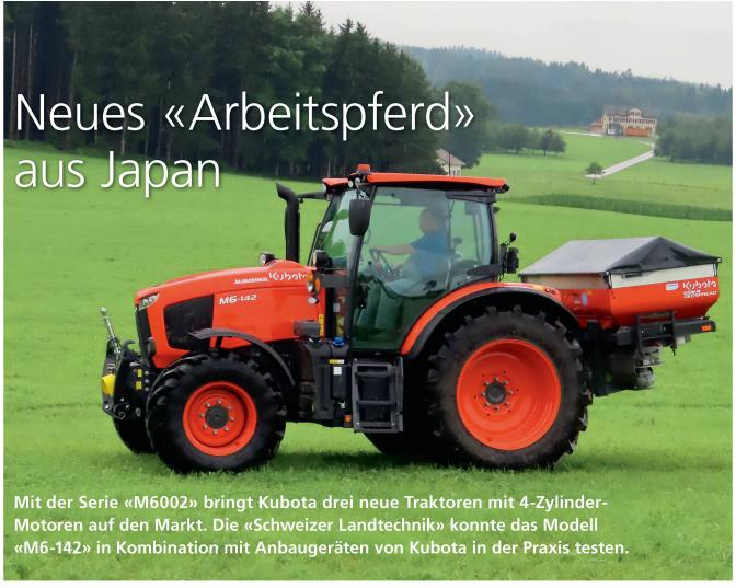
Die Traktorbaureihe «M6» wurde komplett von Kubota entwickelt. Die Fronthydraulik stammt von MX. Bilder: M. Abderhalden
