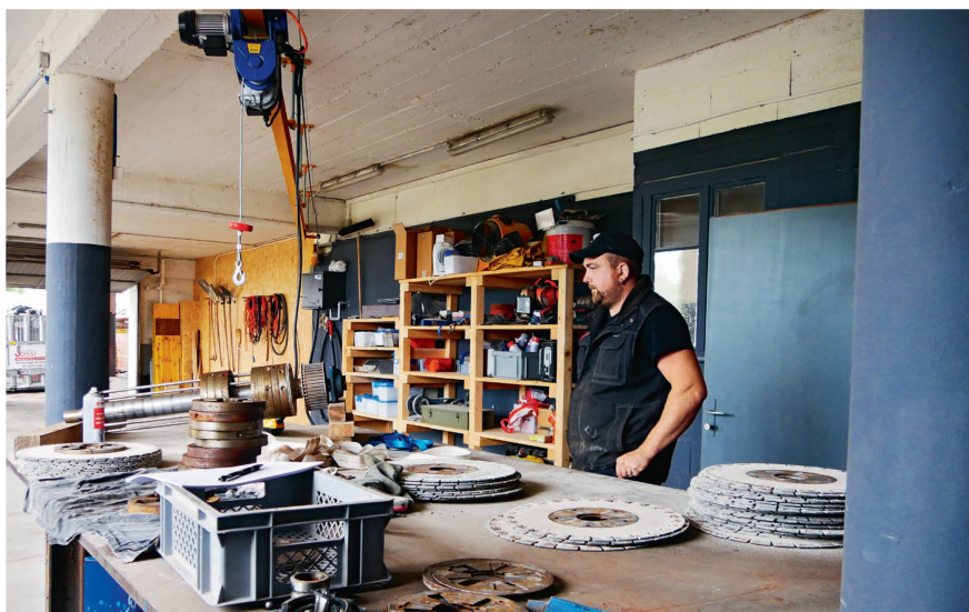
Die Rotorwartung bedingt rund fünf Stunden Arbeit bei der Nutenfrästechnik und anderthalb Tage bei der Rillenfrästechnik. Bilder: M. Schubnel
