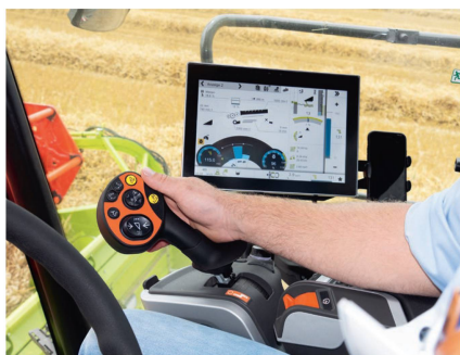
Neben dem Standard-Fahrhebel (Bild) ist auch der «C-Motion»-Griff verfügbar. Im Hintergrund das interaktive «Cemis»-Terminal.
