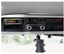
... sowie Bedienelemente für die Klimaautomatik und andere, weniger oft betätigte Funktionen im Dachhimmel.
