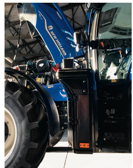
Die Methan-Befüllung erfolgt auf der linken Seite, nahe des Kabinen-Aufstiegs. Ein Manometer zeigt den jeweils aktuellen Füllstand der Tanks an. Bild: M. Schubnel
