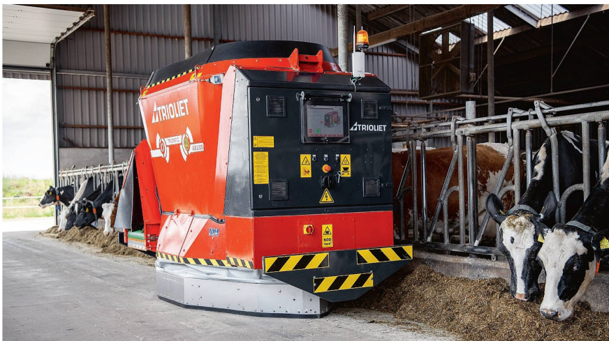
Automatische Futterverteilsysteme sind von der Grundkonzeption her bereits mit einem E-Antrieb ausgerüstet. Bild: Trioliet
