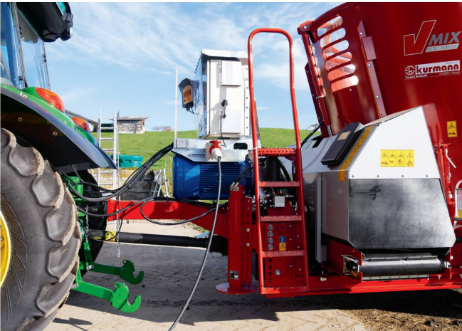
Elektrisch mischen, angehängt fahren und verteilen, dafür gibt es hybride Antriebssysteme. Bild: R. Engeler
