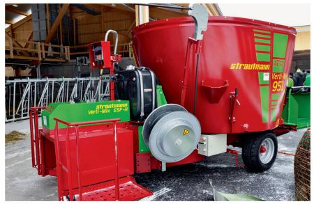
Verschiedene Importeure rüsten die Mischwagen mit einem elektrischen Fahrkopf aus. Bild: R: Hunger
