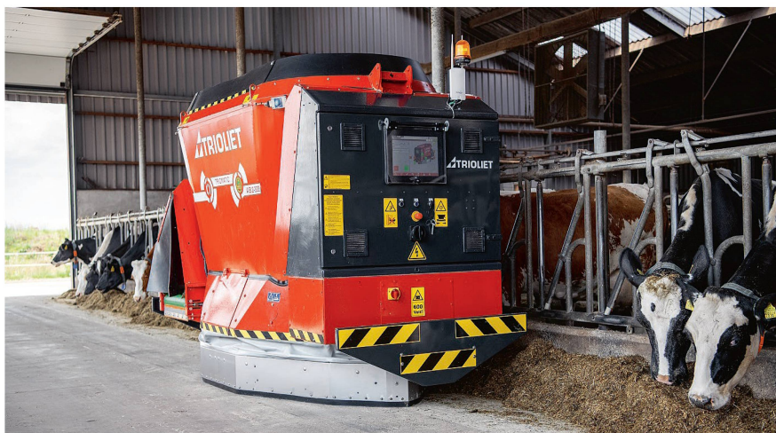
Automatische Futtermittelsysteme sind von der Grundkonzeption her bereits mit einem E-Antrieb ausgerüstet. Bild: Trioliet
