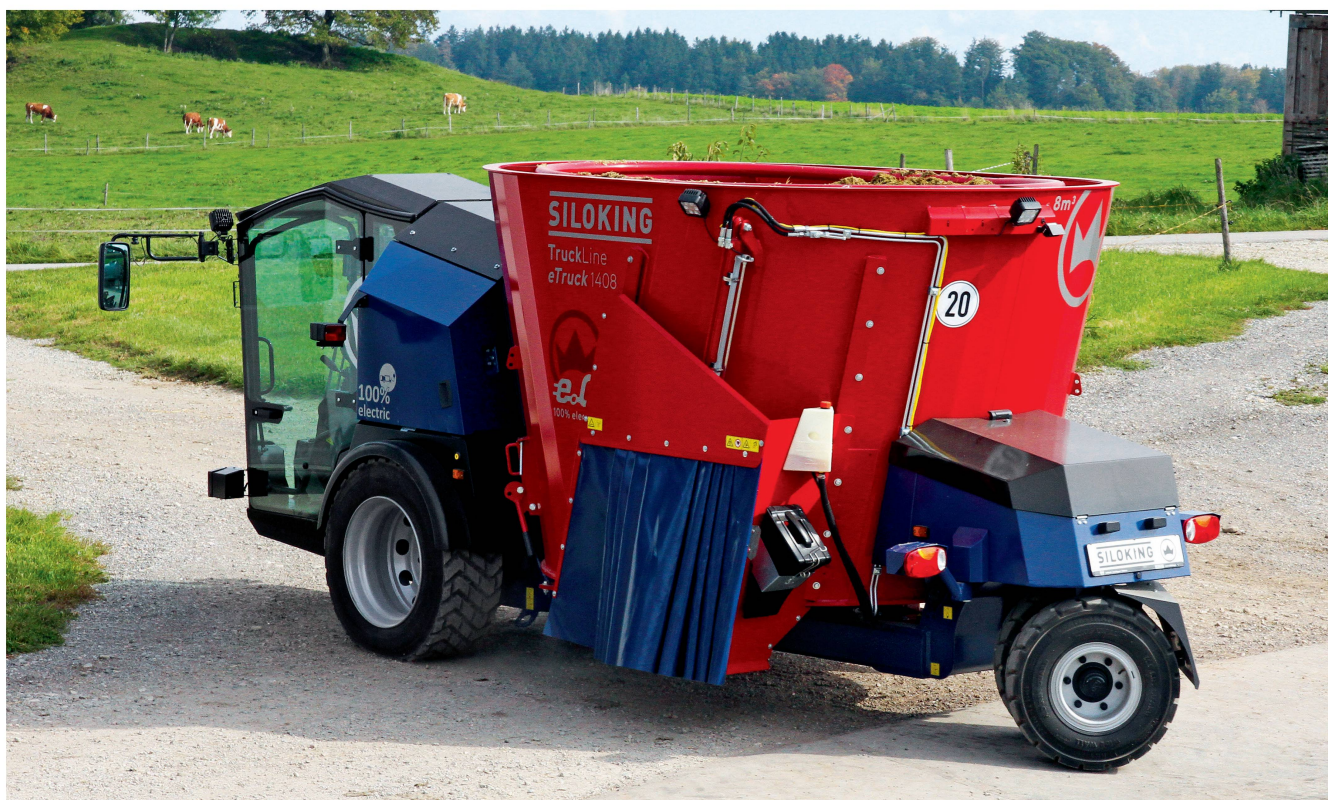
Erfolgreich unterwegs, der Selbstfahrer mit einem leistungsstarken Blei-Säure-Akku. Bild: Siloking
