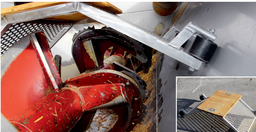
Ein Montagewagen mit Rädern vereinfacht das Arbeiten im Mischbehälter mit liegender Schnecke. Bild: SVLFG, Kassel
