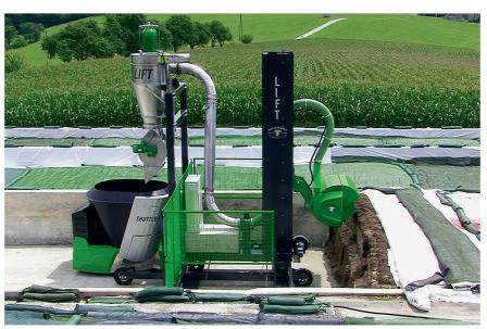
Bei diesem System bleibt das Futter am Fahrsilo und der Fütterungsroboter holt sich die Portionen automatisch an der Frässtation. Bild: Wasserbauer
