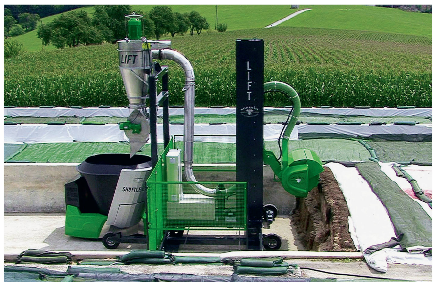
Bei diesem System bleibt das Futter am Fahrsilo und der Fütterungsroboter holt sich die Portionen automatisch an der Frässtation. Bild: Wasserbauer
