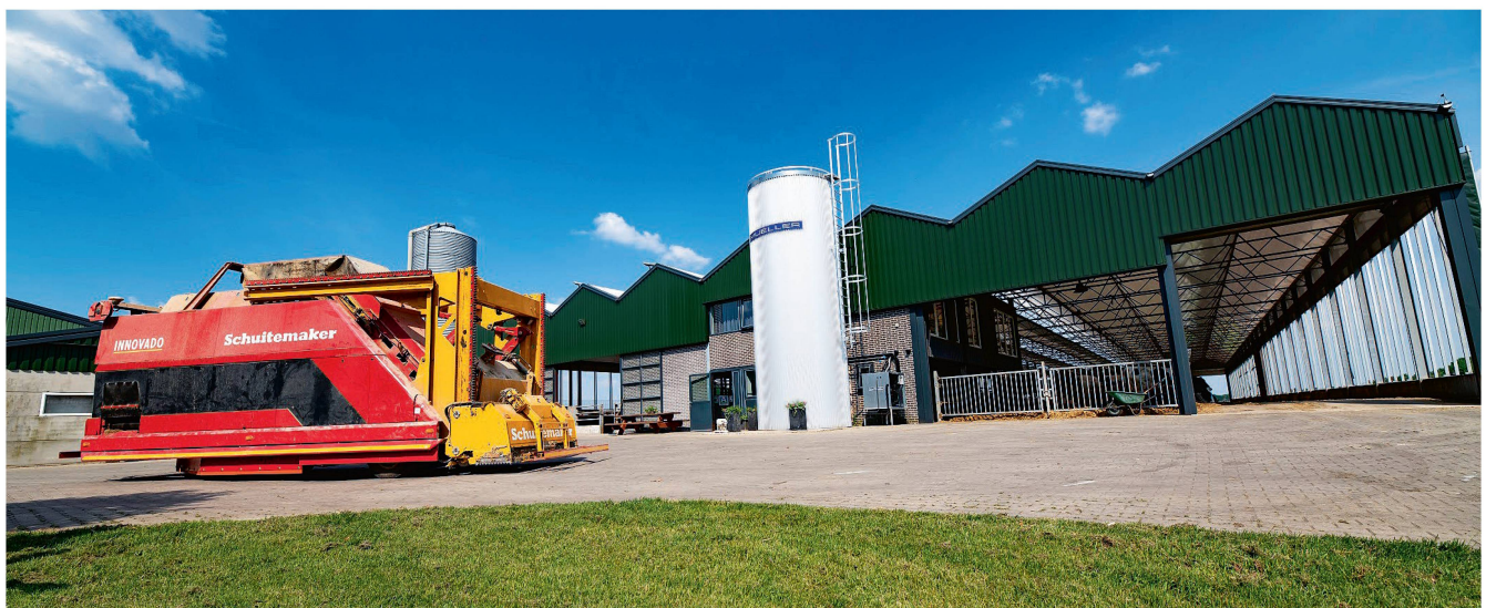
Direkt vom Silo zur Kuh: Der Fahrweg wird durch Transponder und RTK-GPS bestimmt. Bild: Schuitemaker
