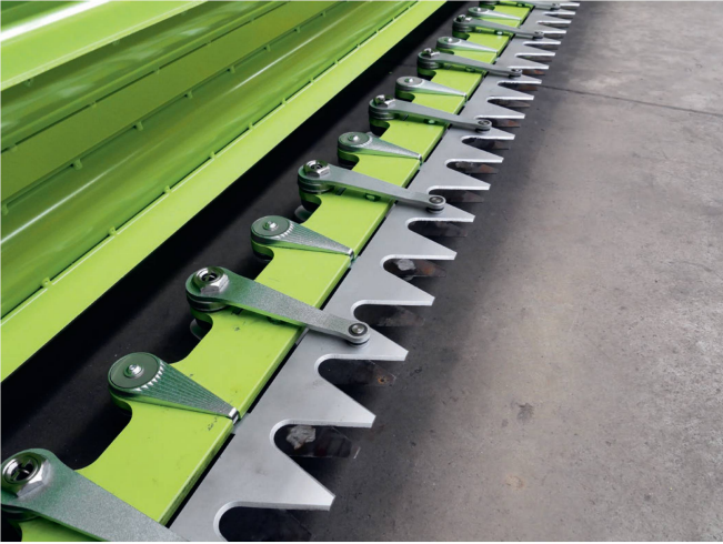
Jeweils ein oberer Schwinghebel führt drei Messer, was dem System eine gute Stabilität verleiht.
