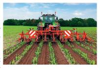
zeuge. In der Abschlussmassnahme wurden ausserdem Häufelschare eingesetzt. Positive Effekte waren in allen Versuchsvarianten nachweisbar. Für die Regulierung von Unkräutern in frühen Wachstumsstadien erwies sich jedoch der Striegel als besonders geeignetes Hackwerkzeug durch Herausreissen und Verschütten der Unkräuter. Bei präziser Einstellung der Hacke liessen sich hohe Wirkungsgrade im Fädchen- bis Keimblattstadium der Unkräuter erreichen.
