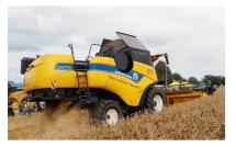
«CH 7.70» mit dem sogenannten «Crossover Harvesting»-Konzept. Dieses System kombiniert die «Twin Rotor»-Separationstechnik mit der konventionellen Dreschtechnologie von New Holland, was zu einer höheren Durchsatzleistung führen soll. Angesiedelt ist der «CH 7.70» zwischen den konventionellen Mittelklasse-Mähdreschern und den Rotor-Flaggschiffmodellen von New Holland.
