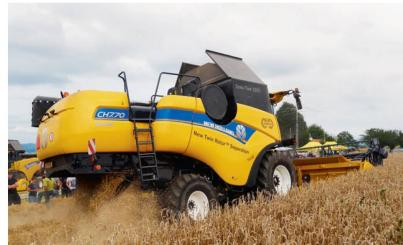
«CH 7.70» mit dem sogenannten «Cross-over Harvesting»-Konzept. Dieses System kombiniert die «Twin Rotor»-Separa-tionstechnik mit der konventionellen Dreschtechnologie von New Holland, was zu einer höheren Durchsatzeleistung führen soll. Angesiedelt ist der «CH 7.70» zwischen den konventionellen Mittel-klasse-Mähdreschern und den Rotor-Flaggschiffmodellen von New Holland.
