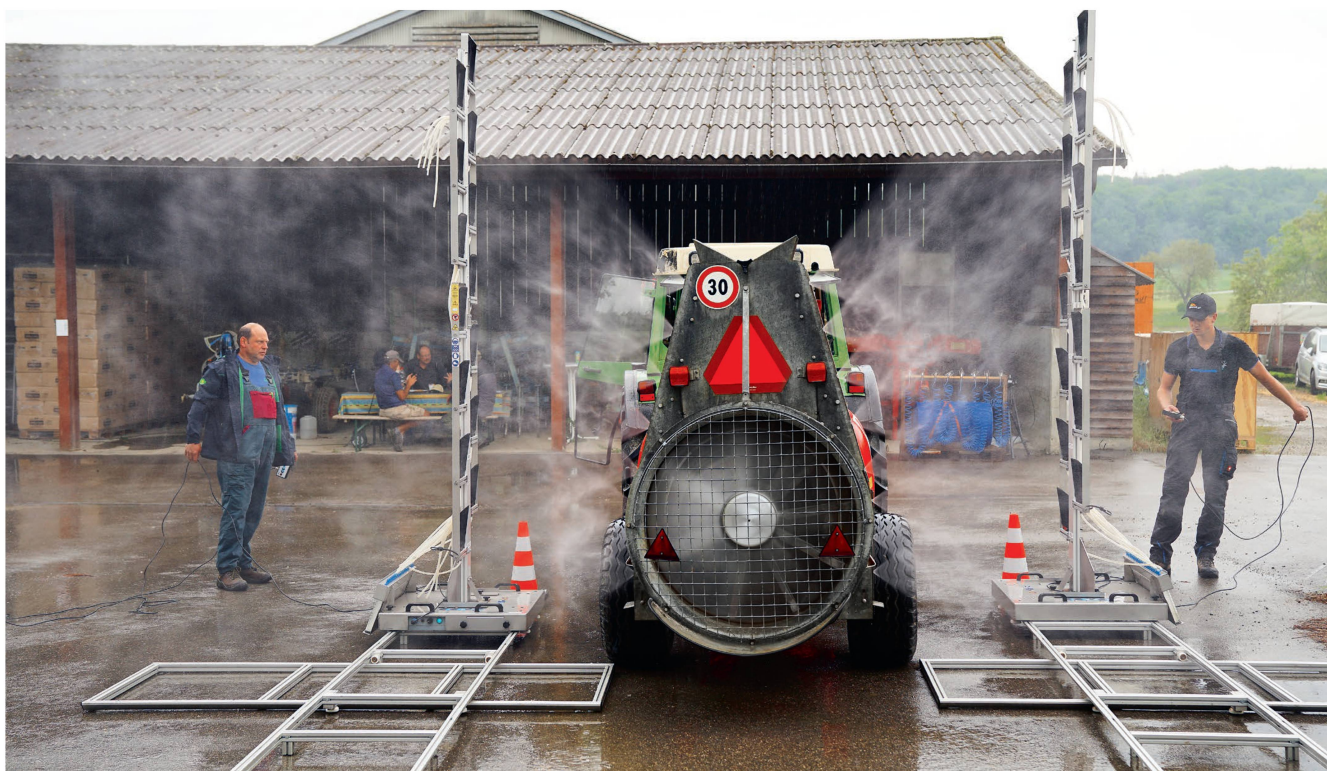
Der neue vertikale Querverteilungsprüfstand für Raumkulturen mit Auffangschalen testet gerade einen Obstsprayer, links Christian Meyer.
