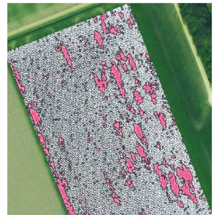
Auf den Drohnenbildern wird mit Hilfe von künstlicher Intelligenz eine Differenzierung von Kulturpflanzen und Unkräutern vorgenommen. Bild: Drone Werkers
