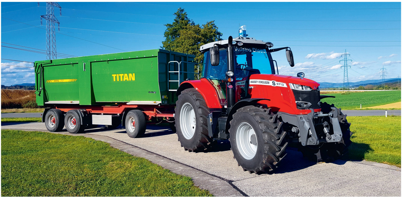
Automatische Streckbremsen in Traktoren mit Stufenlos-Getriebe können Gefahrensituationen entschärfen bis verhindern. Bild: J. Paar
