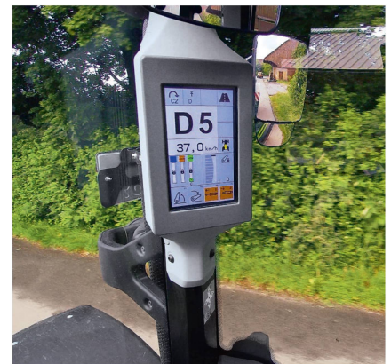
Das farbige 7-Zoll-Display am A-Holm bietet dem Fahrer vollständige Informationen zum Getriebe, zu den elektronischen Steuergeräten und den belegten Funktionstasten.
