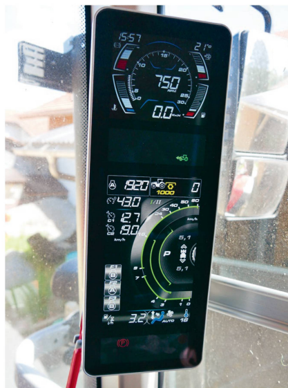
Das serienmässig eingebaute digitale Armaturenbrett mit den Motor- und Getriebeinformationen befindet sich vorne an der rechten Kabinensäule.
