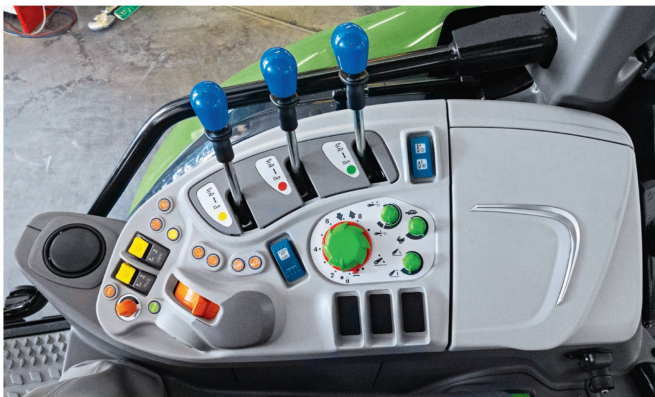
Blick auf die Seitenkonsole mit den Bedienhebeln für die drei mechanischen Steuerventile und das eine elektrische Steuerventil.
