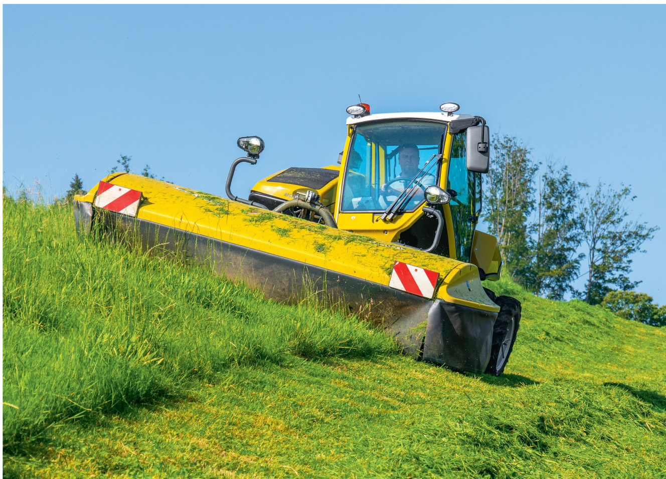
Der Rigitrac-Zweiachsmäher «SKH 60». Die Kabine mit Hangausgleich kann Neigungen bis zu 30% ausgleichen. Bilder: R. Engeler und H. Röthlisberger
