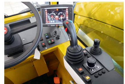
Touch-Terminal, Joystick und Drehrad-Controller sorgen für eine schnelle und komfortable Bedienung des Fahrzeugs.
