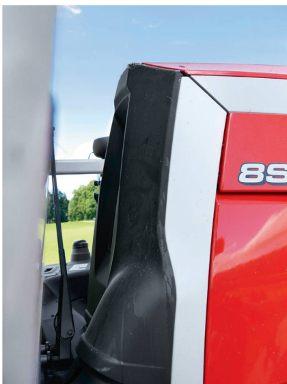
Einzigartig ist der Abstand zwischen Kabine und Haube. Damit soll die Vibration minimiert und Verschmutzung und die Überhitzung begrenzt werden.
