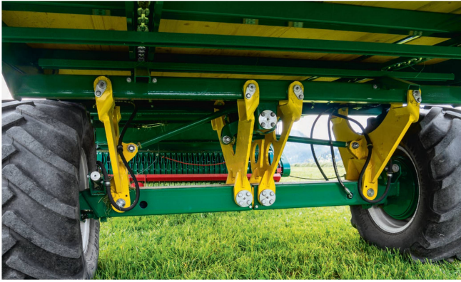
Verstellachse zusammengezogen (links) und ausgefahren (rechts): Im gelben Vierkant-Rohr ist ein Hydraulik-Zylinder verbaut. Die Lenkergeometrie sorgt dafür, dass beide Achshälften sich beim Schub stets synchron bewegen.
