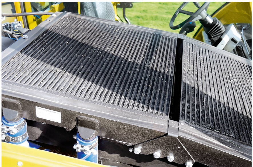
Ein grosser Luftfilter mit Vorabscheider ist Bestandteil der Motorkühlung. Für die Reinigung ist serienmässig ein Umkehrlüfter eingebaut.
