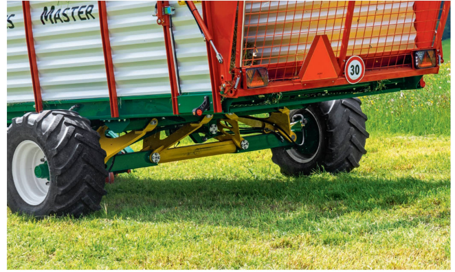
Verstellachse zusammengezogen (links) und ausgefahren (rechts): Im gelben Vierkant-Rohr ist ein Hydraulik-Zylinder verbaut. Die Lenkergeometrie sorgt dafür, dass beide Achshälften sich beim Schub stets synchron bewegen.
