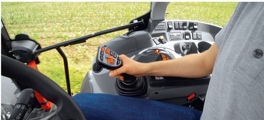
Aufgeräumte Seitenkonsole in «Cis+»-Ausstattung mit Multifunktionsgriff und elektrischen Steuerventilen.
