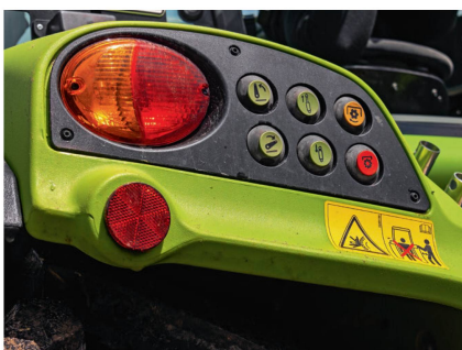
Die externe Bedienung von Heckhubwerk, eines elektronischen Steuergeräts und der Zapfwelle ist auf beiden Kotflügeln möglich.
