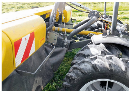
Die Fronthydraulik verfügt über einen hydraulischen Seitenschub von je 19 cm nach links und rechts.
