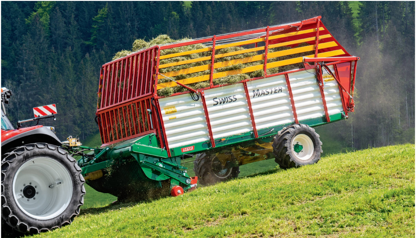
Der Ladewagen «Swiss Master» basiert auf dem Hecklader-Prinzip, das Hersteller Lüönd bei den für Transporter konzipierten Aufbau-Ladewagen verwendet. Bilder: R. Engeler
