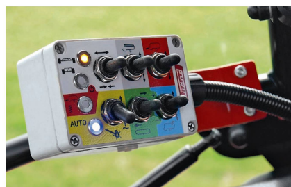
Mit diesem optionalen Panel können alle Funktionen gesteuert werden. Kontrollleuchten zeigen an, ob die automatische Knickdeichsel aktiv ist und in welcher Position die Verstellachse sich befindet.
