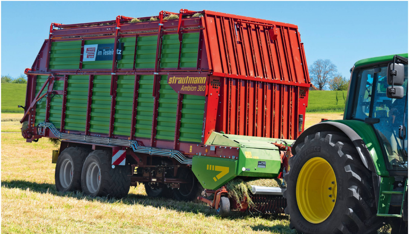
Der Ladewagen «Ambion 360» von Strautmann verfügt über einen grossvolumigen Heuaufbau, der oben mit massiven Profilen aus Stahl abgeschlossen ist. Bilder: R. Engeler
