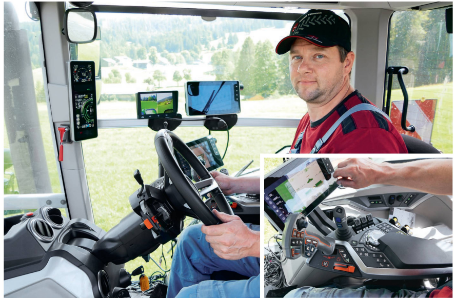
Mit der neuen Armlehne hat der Fahrer leichten Zugang zu allen Steuerungen. Auch zum Hauptterminal, das jetzt über einen Touchscreen verfügt. Der Fahrersitz ist um 45° drehbar.
