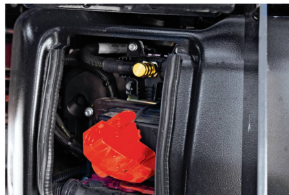
Unter dem rechtsseitigen Kabinaufstieg ist die Batterie untergebracht, die neu über einen Plus-Pol zur direkten Überbrückung verfügt.
