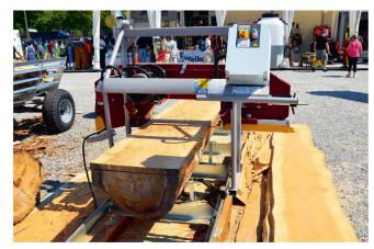
Alle vergleichbaren Sägewerke können auf ein Fahrwerk aufgebaut und mit Pick-up oder Traktor transportiert werden. Bild: R. Hunger
