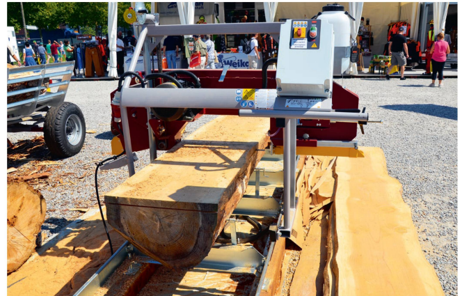
Alle vergleichbaren Sägewerke können auf ein Fahrwerk aufgebaut und mit Pick-up oder Traktor transportiert werden. Bild: R. Hunger
