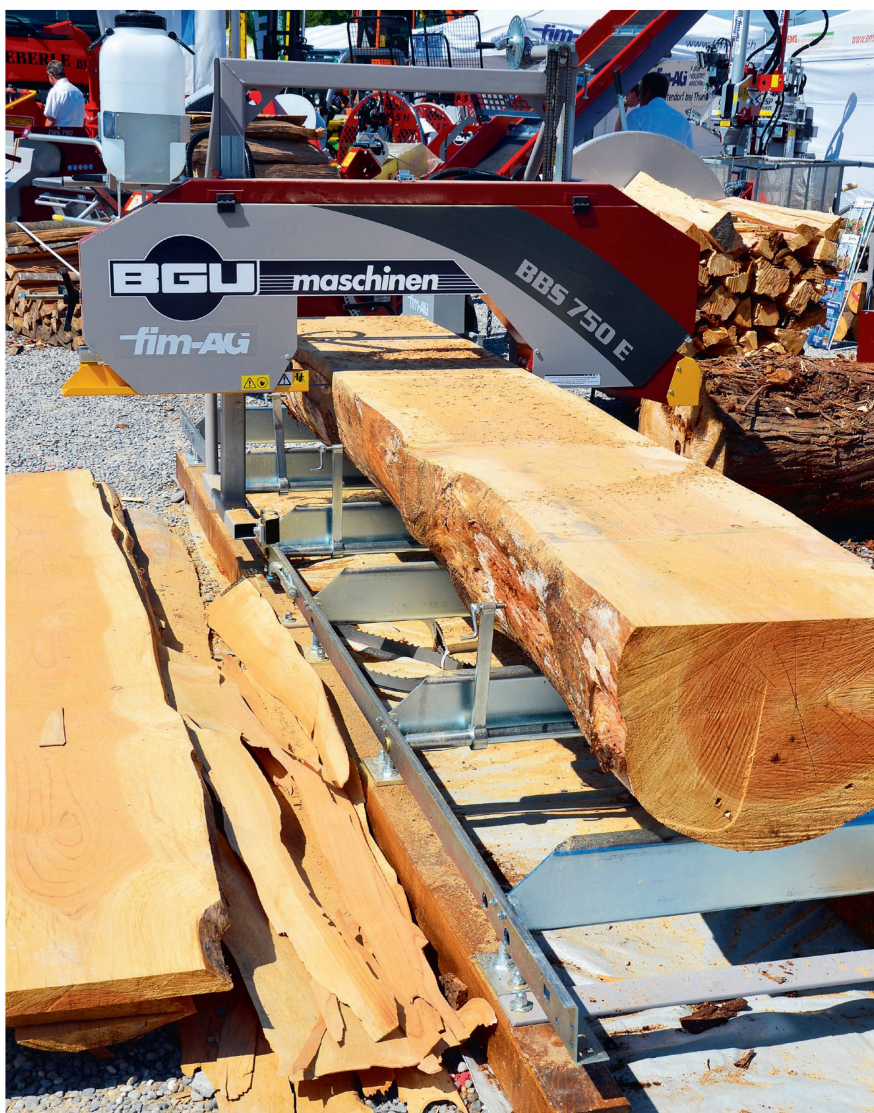
Voraussetzung für hohe Schnittleistung und Schnittqualität ist eine feste Fixierung des Blocks auf dem Sägebett. Bild: R. Hunger
