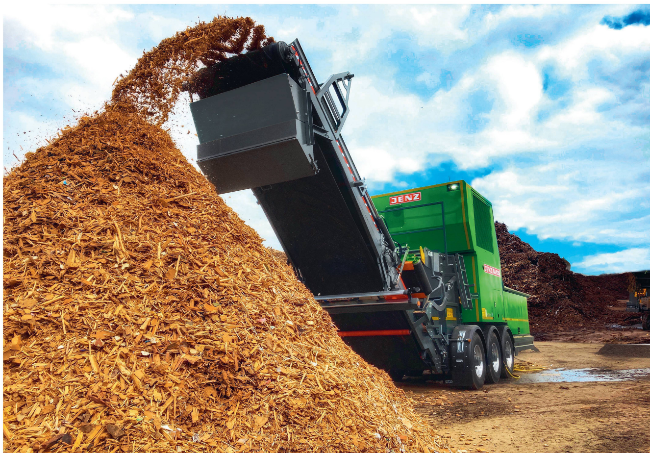
Schredder erzeugen uneinheitliche, faserige, gebrochene Holzschnitzel. Bild: Jenz
