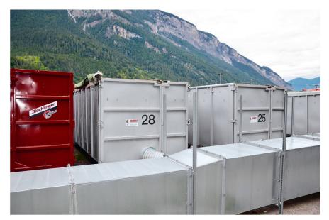
Bei der Container-Trocknung wird das Trocknungsgut von unten mit heisser Luft durchströmt. Bild: R. Hunger
