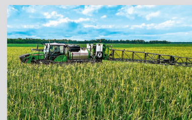
In Europa (noch) nicht erhältlich: Der Selbstfahrer «Rogator 900» kann mit entsprechenden Aufbauten sowohl als Feldspritze als auch als Düngerstreuer genutzt werden.
