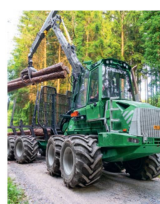
Titelbild: Holz rücken mit einem Forwader des Typs «1250F» von Gremo: Dank gestiegener Holzpreise wird die Arbeit im Wald wieder wirtschaftlicher.
