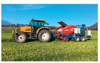
Der «Ares 620 RZ» mit 120-PS-6-Zylinder-Motor vor der Kombi-Rundballenpresse; der grosse Radstand verrät die hervorragende Gewichtsverteilung.
