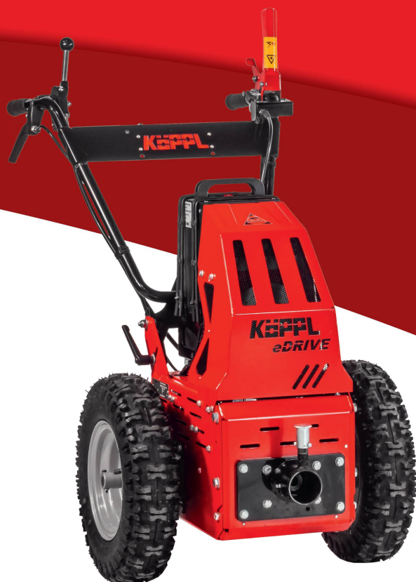
«Kompakt Easy eDrive» (CEE): Der 48-V/40-Ah-Köppl-Akkupack und das Standard-Ladegerät sind bereits im Lieferumfang enthalten.
