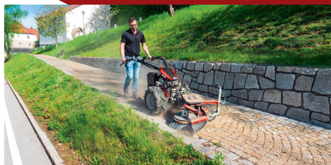
Ökologische Wildkrautbeseitigung und Pflasterreinigung mit «Kompakt Comfort eDrive» (CCE) und Köppl-Anbaugerät «KWE53».
