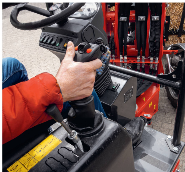
Joystick und Hebel für den dritten Steuerkreis lassen sich vertikal eindrücken, so dass die Steuerungsfunktion ausgeschaltet ist.
