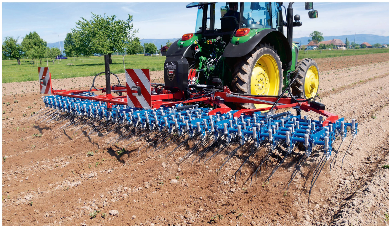
Gleicher Zinkendruck über die gesamte Maschinenbreite: Der 6-Meter-Hatzenbichler mit dem Zinkenfedersystem «AirFlow» beim Striegeln in einem Kartoffelfeld. Bilder: H. Röthlisberger
