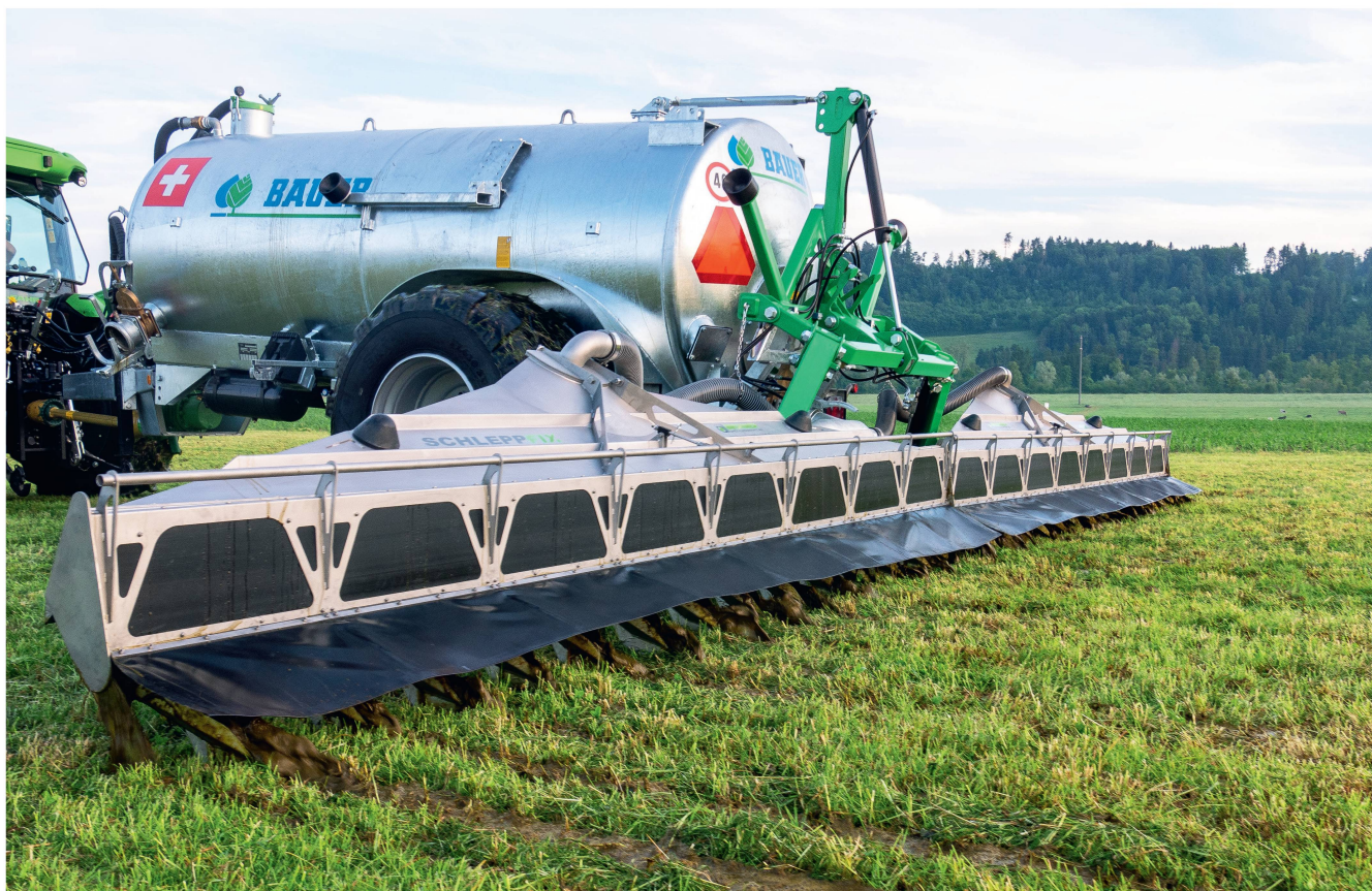
Der Gülleverteiler «Schlepp-Fix» in der 9-m-Ausführung mit insgesamt 30 Abgängen im Abstand von 30 cm. Bilder: R. Engeler
