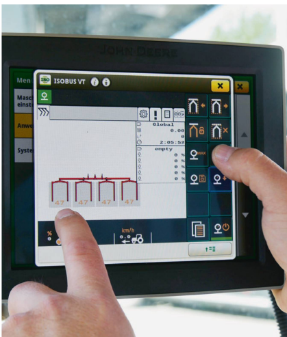
Jedes Striegelfeld kann über das Isobus-Terminal am Traktor einzeln eingestellt werden.
