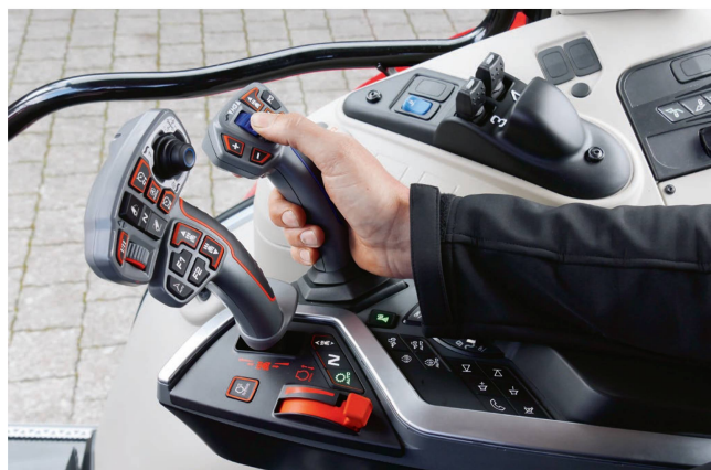
Auf dem «Multipad»-Fahrhebel (links) ist ein Mikro-Joystick integriert, mit dem sich zwei frei belegbare Steuerventile bedienen lassen. Rechts ist der Joystick für die Frontlader-Steuerung.
