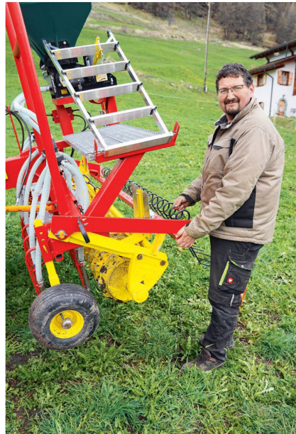
Nicolas Gaudin hebt die nachlaufende Kuhn-Deckegge zur Einarbeitung des Saatguts an.
