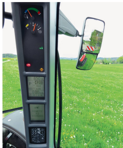
Die Anzeigen an der A-Säule ersetzen das Armaturenbrett.
