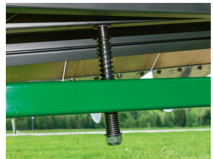
Über einen mittigen Drehpunkt kann jede Einheit zudem in sich frei und federgedämpft pendeln.
