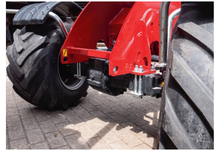
Die Achsen stammen von Comer, die Räder weisen einen Einschlag von 38° auf.
