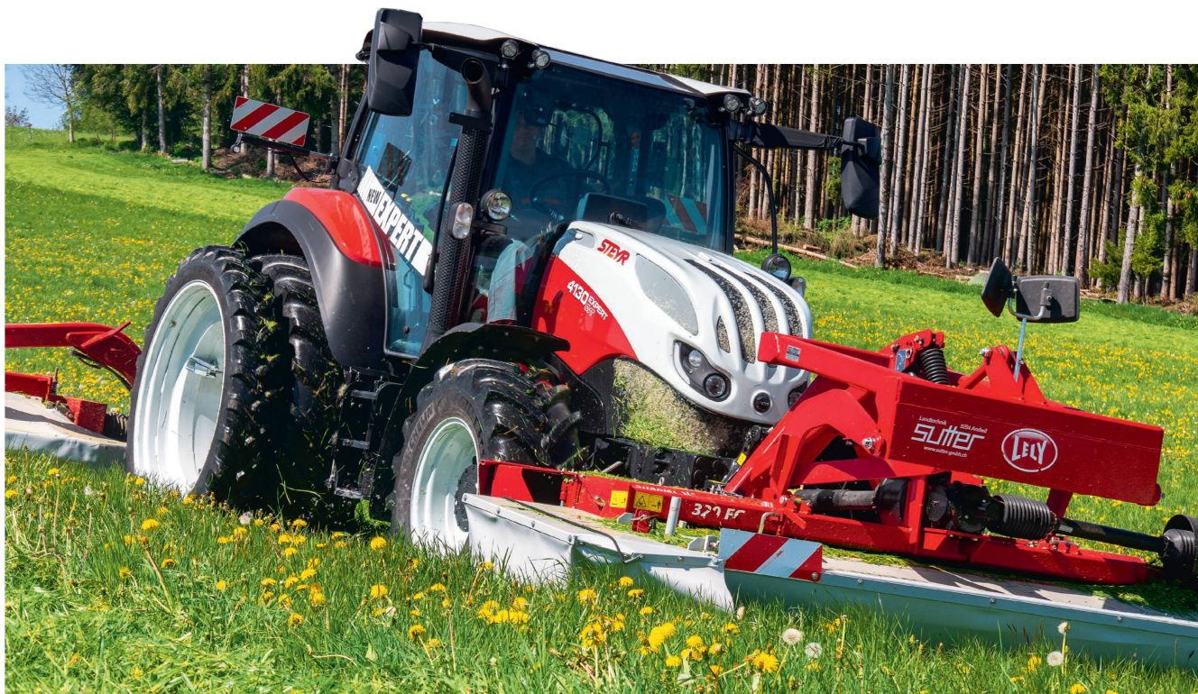
Mit der 6,40 m breiten Mähkombination inklusive Aufbereiter war der Steyr «Expert 4130 CVT» gefordert. Die Bereifung mit Doppelrad hinten passte für die Hanglagen ideal. Bilder: R. Engeler, M. Abderhalden
