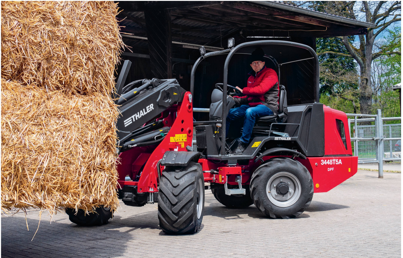
Mit den Modellen «5A» kombiniert Thaler bei seinen Hofladern die übliche Knick- mit einer Achsschenkel-Lenkung bei allen vier Rädern.
