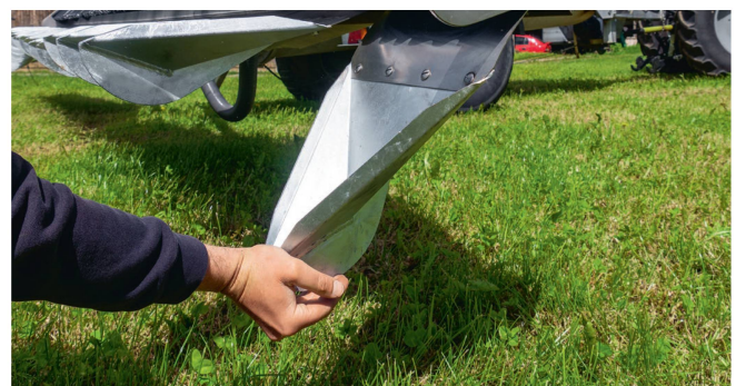
Die Gülle fließt in diesen Dreiecksschuh mit Hardox-Gleitkufe. Der Schuh ist mit rostfreiem Federstahlblech am Verteiler befestigt.
