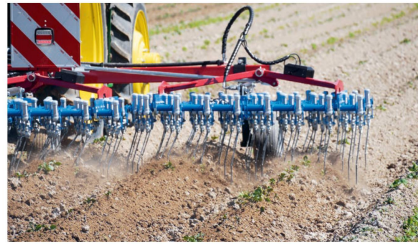
Durch den Druck erreichen die Zinken auch die Flanken der Dämme.
