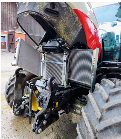
Grosse Ansaugflächen bringen viel Frischluft, die einfach ausklappbaren Kühler sind gut zu reinigen.
