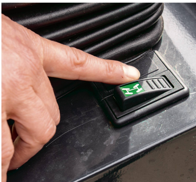
Über diesen Kippschalter rechts der Lenksäule wird die Lenkungsart für die Räder bestimmt.
