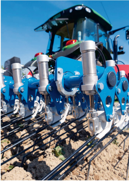
Jeder Zinken hat einen Luftzylinder, der einen Druck bis zu 5 kg erzeugen kann.
