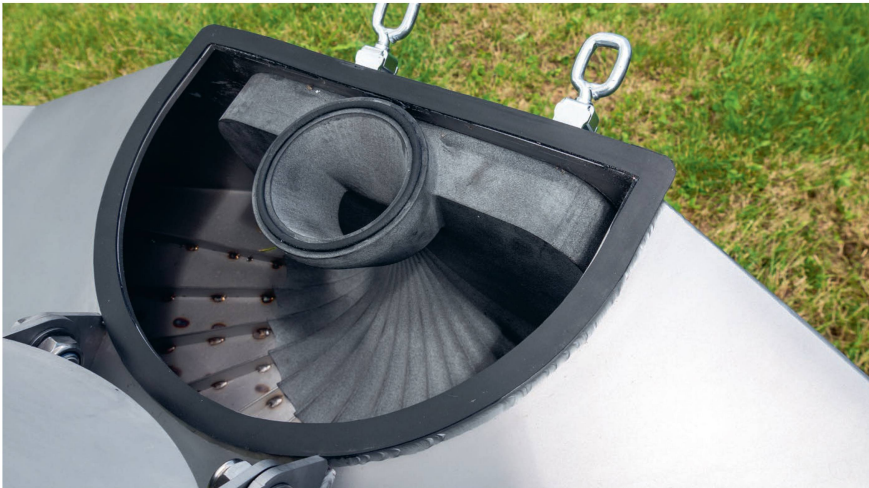
Herzstück beim «Schlepp-Fix» ist dieses Kunststoff-Teil aus dem 3-D-Drucker: Die Gülle fließt durch den Ring, die gerippte Fläche sorgt für das Verbreitern des Güllestroms auf die gesamte Arbeitsbreite.
