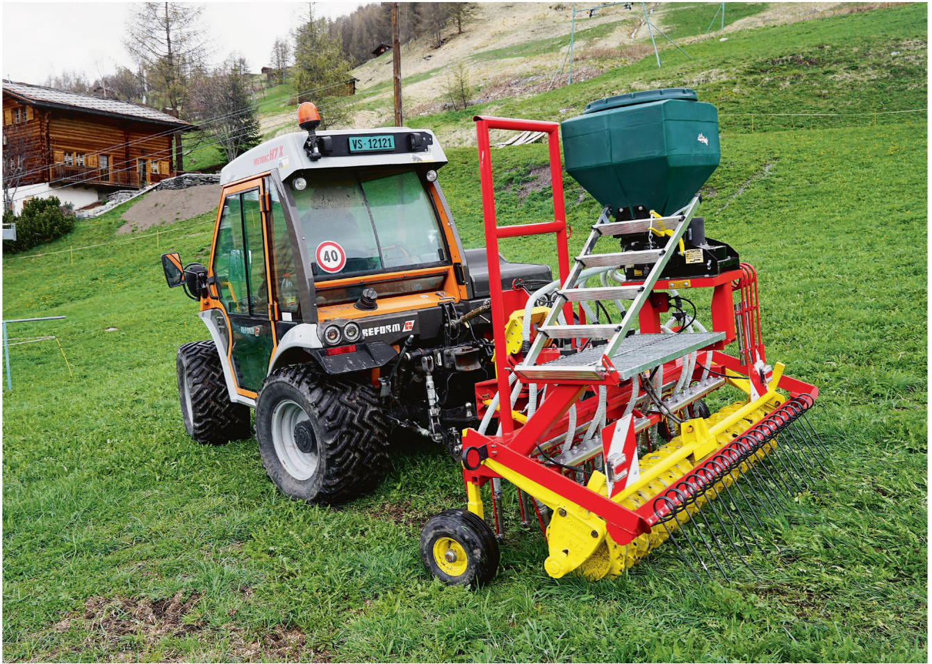
Nur 650 kg schwer: Die nachlaufende Wiesenübersaatmaschine Marke Eigenbau am Reform «Metrac H7 X» auf dem Betrieb von Nicolas Gaudin in La Forclaz im Kanton Wallis. Bilder: D. Senn
