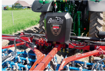
Der «Pack-Controller» regelt den Luftdruck und gibt diesen an die Zylinder weiter.
