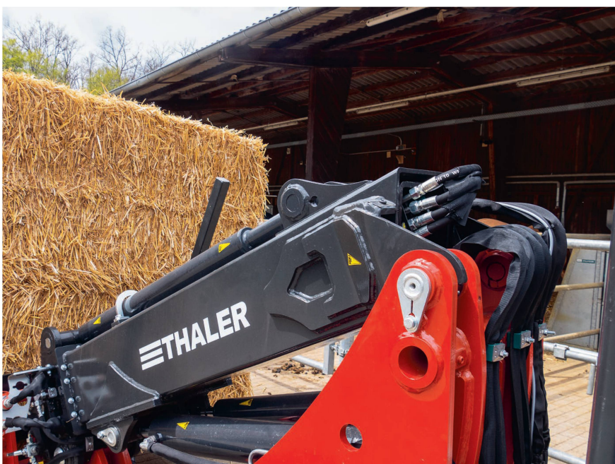
Der Hubarm wird über einen Hub- und einen Ausgleichszylinder bewegt.
