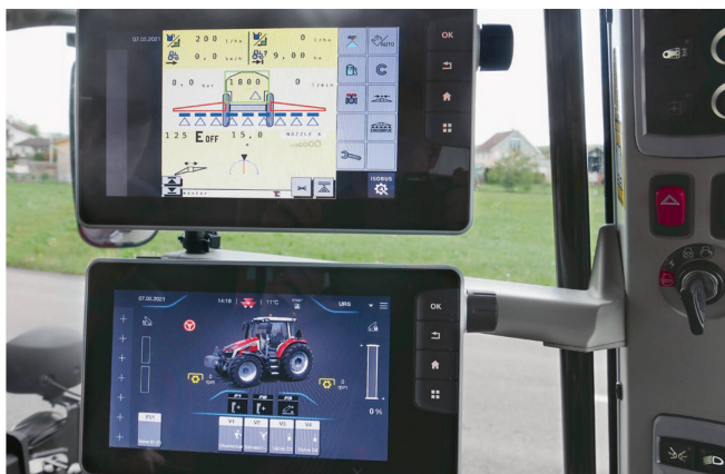
Der «Datatronic 5»-Touchscreen (unten) kann mit dem «Fieldstar 5»-Terminal ergänzt werden, so dass GPS- und Isobus-Funktionen separat abgebildet werden können.
