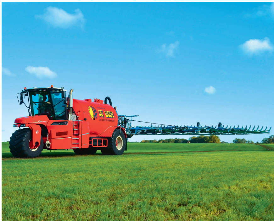
Das «Hydro Trike» von Vervaet vermeidet dank mittig angeordnetem Lenkrad Mehrfachbefahrungen ganz. Bild: zvg
