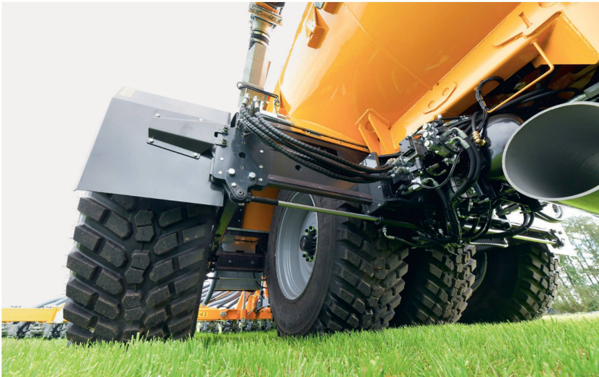
Teleskopierbare Achsen reduzieren die Anzahl der Druckspitzen in der Traktorspur und verbessern nebenbei die Hangtauglichkeit. Bild: zvg
