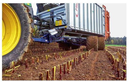
Schwere Maschinen können den Boden auf eine unerwünschte Art und Weise «bearbeiten». Fahrwerke mit Hundegang reduzieren den Anteil mehrfach befahrener Fläche. Bild: R. Burkhalter
