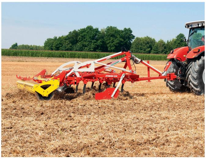
Selbst wenn mit dem Grubber tief gelockert wird, bleibt ein Grossteil des Strohs im Bereich von 0 bis 5 cm liegen. Bild: Pöttinger
