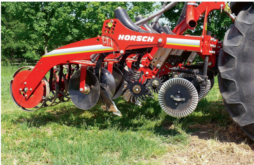
Grundaufbau mit Schneidscheibe, Räumsternen, Lockerungszinken und Hohl-scheiben zur Dammformung. Bild: zVg
