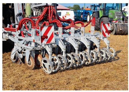
Gülledüngung unter der Erdoberfläche kann vor oder während der Saat durchgeführt werden. Bild: R. Hunger
