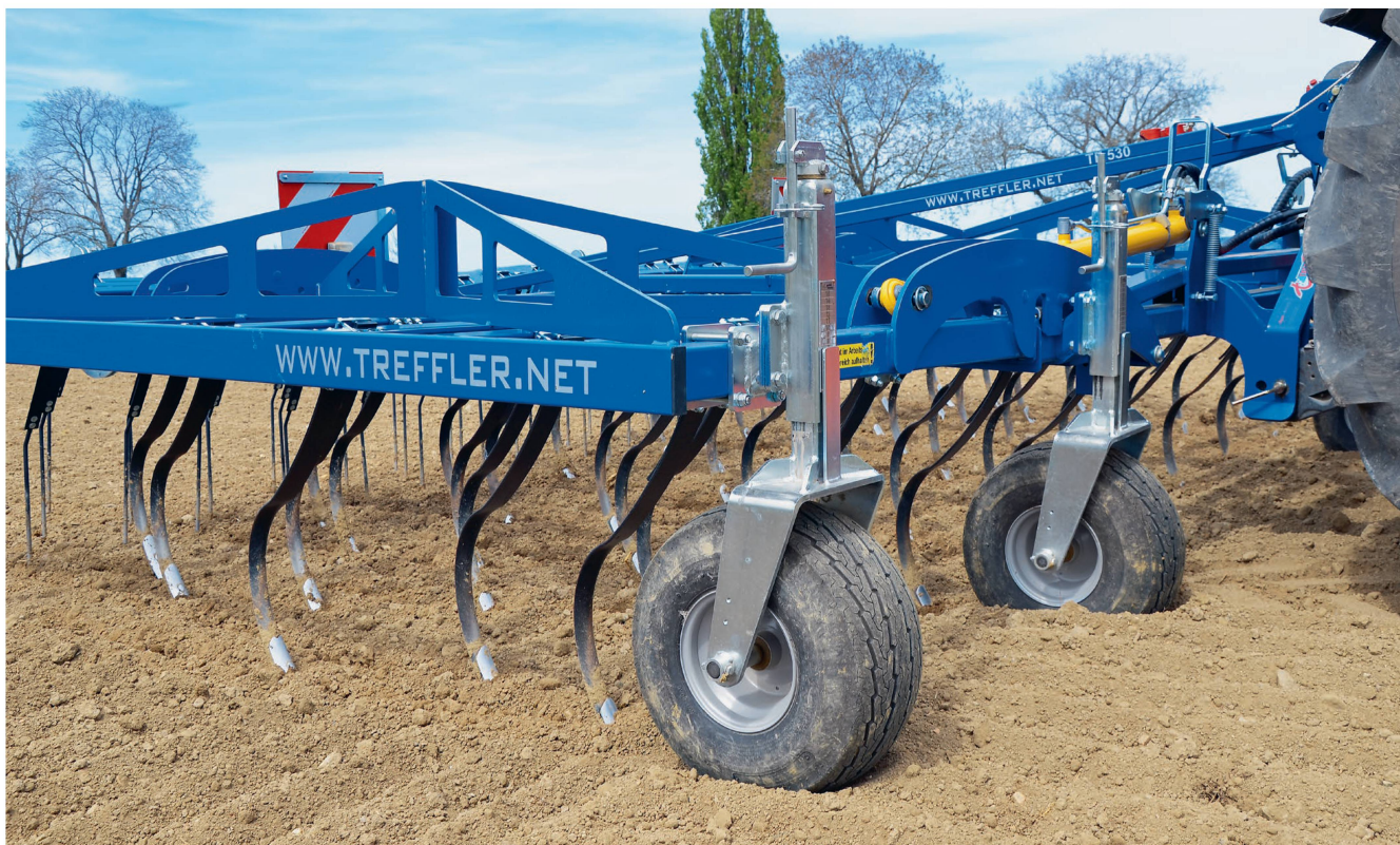
Das spezielle Design dieser Zinken erlaubt auch bei Ernterückständen ein verstopfungsfreies Arbeiten. Bild: R. Hunger
