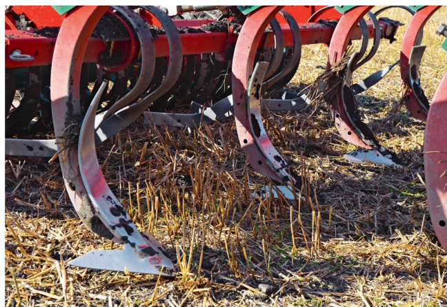
Die Grubberschar bestimmt, wie gut flaches Arbeiten im Bereich von wenigen Zentimetern möglich ist.
