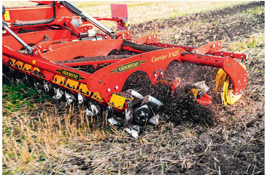
Die speziell geformten CrossCutter Disc haben ein über 11 cm breites Profil, das einen ganzflächigen, 2 bis 3 cm tiefen Schnitt ermöglicht. Bild: Väderstad
