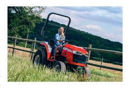
hydrostatischem oder mechanischem Fahrantrieb ausgestattet. Es gibt sie mit 3-Zylinder-Motoren (1,8 l Hubraum) und mit 4-Zylinder-Aggregaten (2,4 l Hubraum). Die neuen Traktoren ergänzen die Modelle «MF 1520» und «MF 1525». Mit der Einführung dieser Baureihe hat Massey Ferguson nun sein gesamtes Angebot an Traktoren für kleinere landwirtschaftliche Betriebe, die Grundstückpflege und den Freizeitsektor komplett erneuert.
