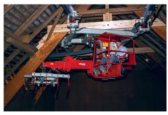
Bächtold baut auch Spezialanfertigungen. Hier ein Heukran mit Obenläufer-Kurvenfahrwerk.
