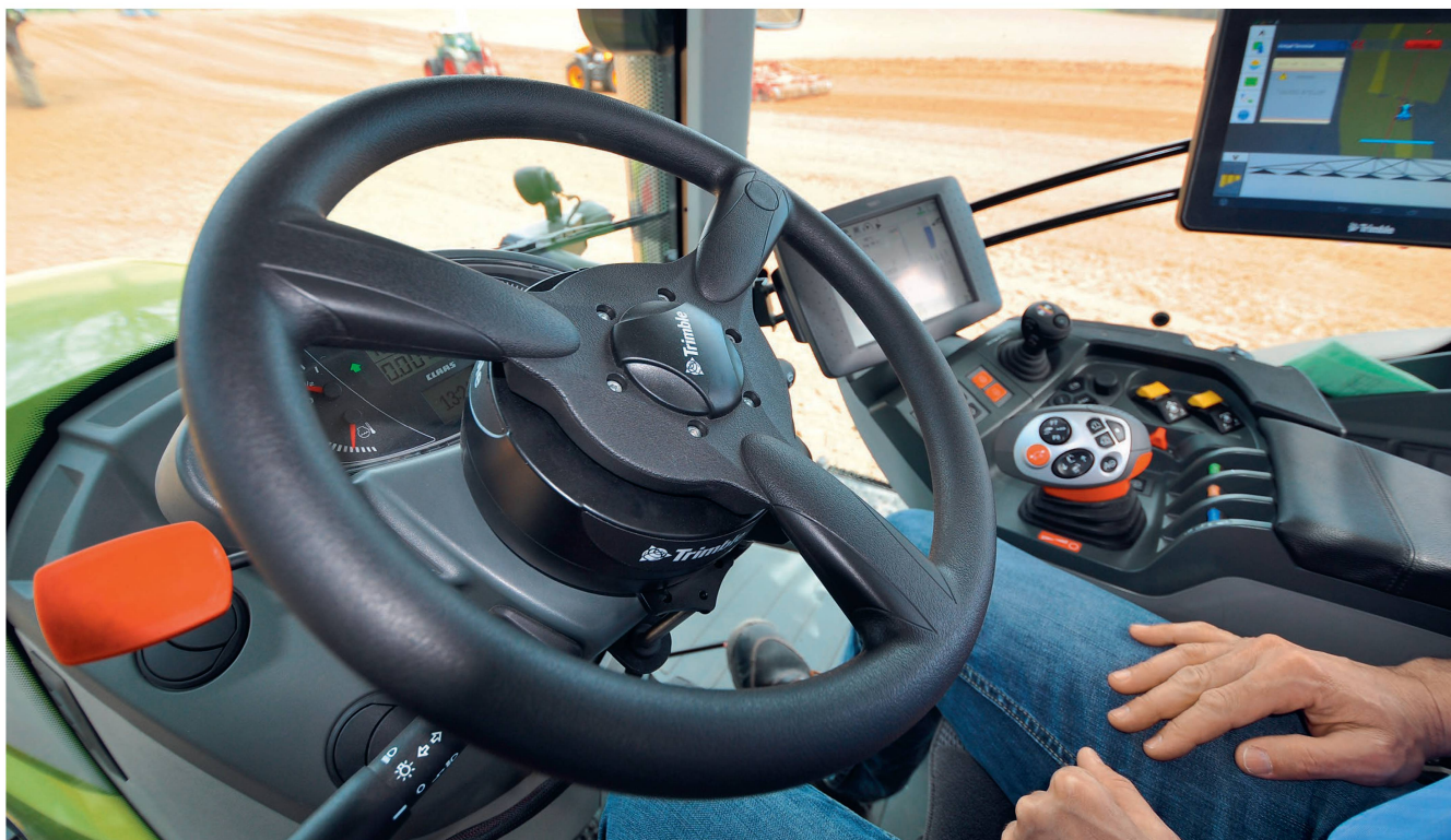
Traktoren oder Erntemaschinen, die nicht vorgerüstet sind, können mit Lenkassistenten-Lenkautomaten nachgerüstet werden. Bild: R. Engeler
