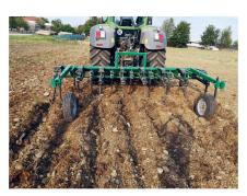
Die Werkzeuge des Häufelpfluges sind durch eine Bruchsicherung abgesichert. Bild: Turiel
