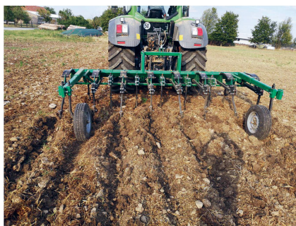
Die Werkzeuge des Häufelpfluges sind durch eine Bruchsisicherung abgesichert.
