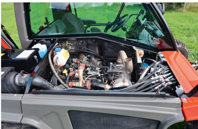
Reform startet mit einem neuen Motorhersteller in die neue «Metrac»-Ära: Der Perkins-4-Zylinder leistet 75 PS bei 2200 U/min.
