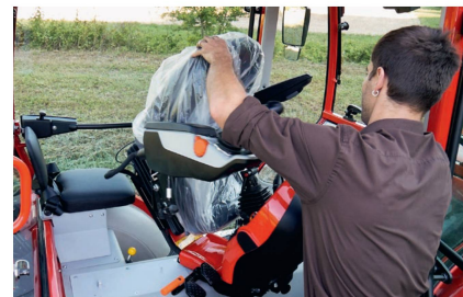
Für die Sitzdrehung braucht es 20 Sekunden: Fusspedale hochklappen, Sicherung lösen, Sitz anheben und drehen – fertig.
