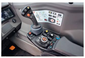
Der Multifunktions-Joystick vereint alle Funktionen, die für die Steuerung der Anbaugeräte sowie für den Fahrantrieb nötig sind.
