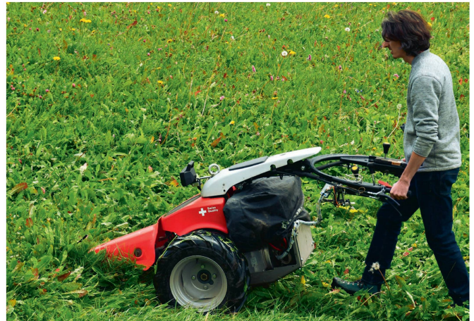
Knackpunkt ist derzeit noch das Gewicht der hier noch abgedeckten Batterie.
