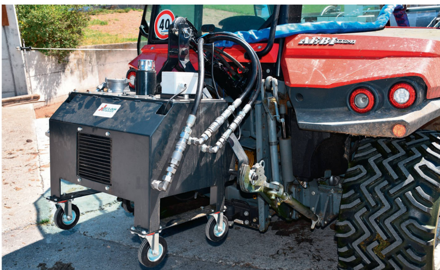
Für Zweiaxsmäher bis 2000 kg Eigengewicht gibt es die Antriebseinheit als Heckgewicht für den 3-Punkt-Anbau.
