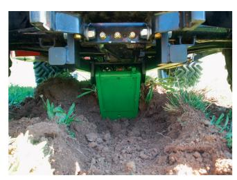
Je nach Fahrtrichtung bohrt sich eine der beiden massiv konstruierten Bremsklappen wie ein Rettungsanker in den Boden und stoppt das Fahrzeug.
