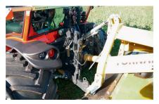
Optional leistet die Hydraulikpumpe 52 l/min (serienmässig 44 l/min). Es stehen total vier Steuerventile zur Verfügung.
