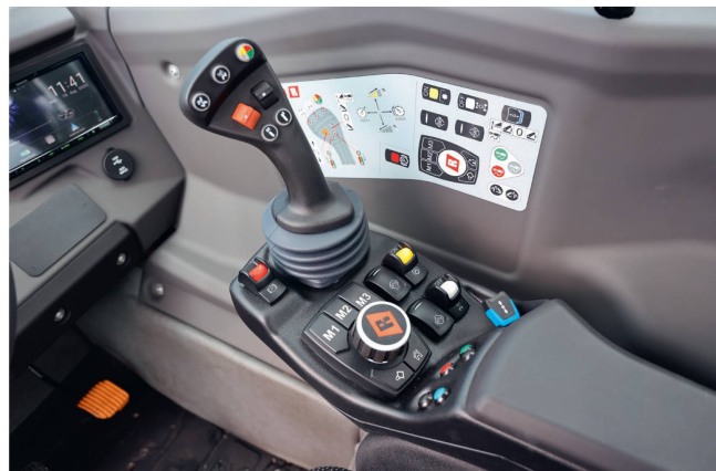
Der Multifunktions-Joystick vereint alle Funktionen, die für die Steuerung der Anbaugeräte sowie für den Fahrtrieb nötig sind.
