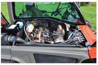
Reform startet mit einem neuen Motorhersteller in die neue «Metrac»-Ära: Der Perkins-4-Zylinder leistet 75 PS bei 2200 U/min.
