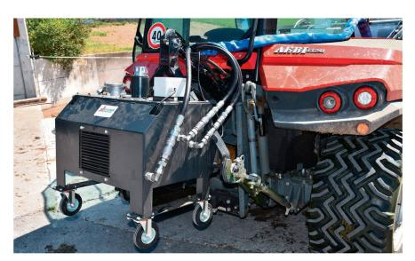
Für Zweiachsmäher bis 2000 kg Eigengewicht gibt es die Antriebseinheit als Heckgewicht für den 3-Punkt-Anbau.
