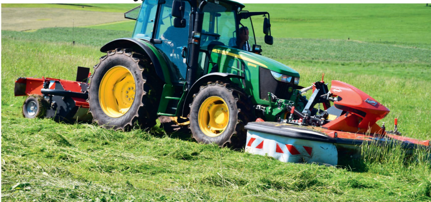
Das Mähwerk kann auch mit einem heckseitigen Aufbereiter eingesetzt werden.
