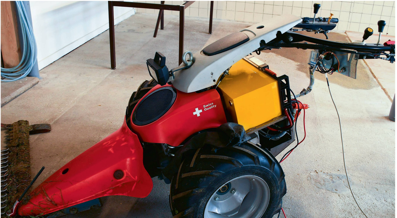
Ein ungewöhnlicher Anblick. Anstelle des Vanguard-Motors ist bei diesem Motormäher ein E-Kit montiert. Bilder: R. Hunger
