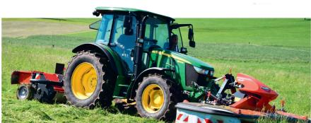
Das Mähwerk kann auch mit einem heckseitigen Aufbereiter eingesetzt werden.
