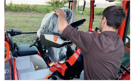
Für die Sitzdrehung braucht es 20 Sekunden: Fusspedale hochklappen, Sicherung lösen, Sitz anheben und drehen – fertig.
