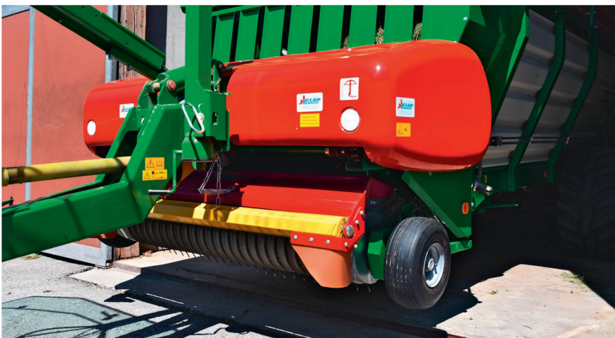
Wichtiges Detail: die seitliche Gummiabdeckung verhindert das Wegrutschen von kurzem Futter am Hang.
