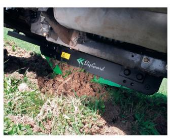
Die Bergung eines mit «SlipGuard» abgebremsten Fahrzeuges kann etwas aufwändig sein, da sich das System mit Erdmaterial füllt.
