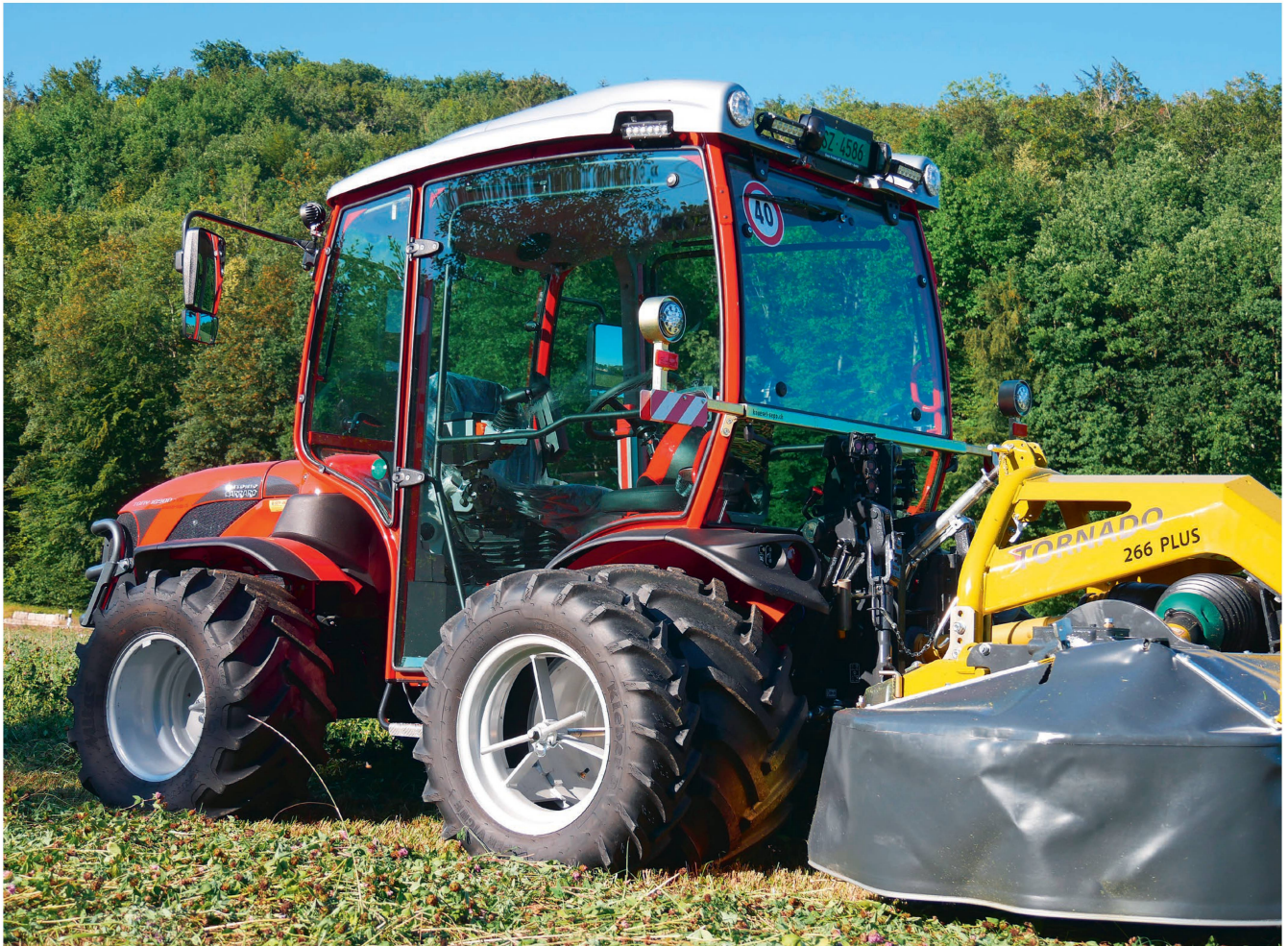
Der tiefe Schwerpunkt und die zentrale Fahrerposition machen zusammen mit angebrachten Doppelbereifungen den rund 2,9 t schweren «Tony 10900 TTR» in vielen Einsatzgebieten zu einem echten Mitbewerber des Zweiaxsmähers. Bilder: R. Engeler
