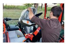
Für die Sitzdrehung braucht es 20 Sekunden: Fusspedale hochklappen, Sicherung lösen, Sitz anheben und drehen – fertig.
