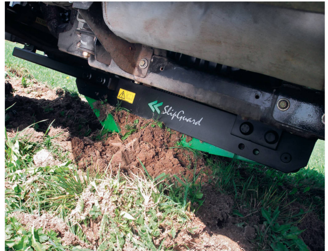
Die Bergung eines mit «SlipGuard» abgebremsten Fahrzeuges kann etwas aufwändig sein, da sich das System mit Erdmaterial füllt.
