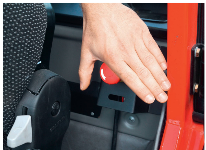
Die Notstopp-Einrichtung kann elektrisch (Not-Aus) mit einem starken Magneten oder auch mechanisch per Seilzug ausgelöst werden.
