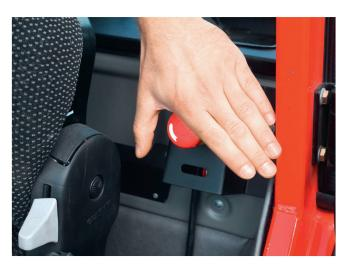
Die Notstopp-Einrichtung kann elektrisch (Not-Aus) mit einem starken Magneten oder auch mechanisch per Seilzug ausgelöst werden.
