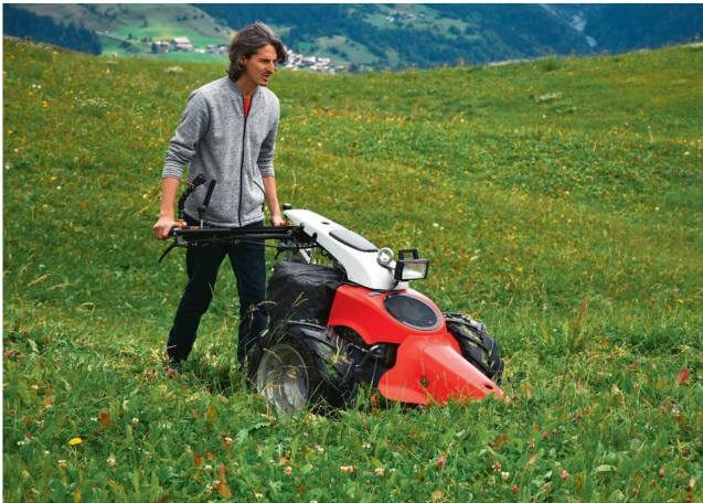
«Normalerweise» bewegt sich der Maschinenführer im Bereich der Abgase, nicht so mit diesem E-Antrieb.
