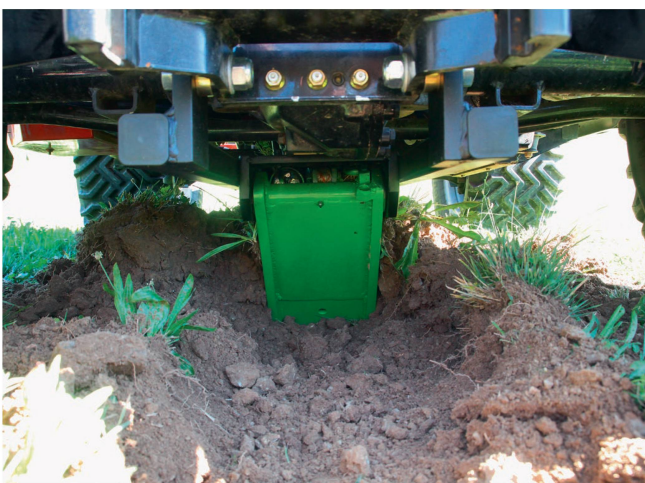
Je nach Fahrtrichtung bohrt sich eine der beiden massiv konstruierten Bremsklappen wie ein Rettungsanker in den Boden und stoppt das Fahrzeug.
