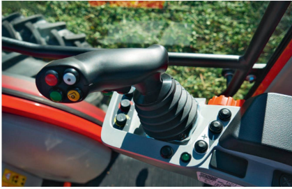
Über den Joystick werden die meisten Hydraulik-, Hubwerks- und Zapfwellenfunktionen gesteuert.
