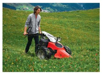
«Normalerweise» bewegt sich der Maschinenführer im Bereich der Abgase, nicht so mit diesem E-Antrieb.
