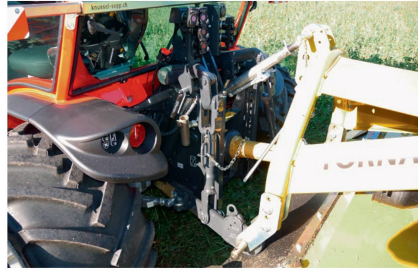
Optional leistet die Hydraulikpumpe 52 l/min (serienmässig 44 l/min). Es stehen total vier Steuerventile zur Verfügung.
