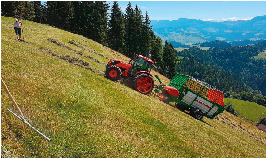
Im steilen Gelände auf der Goldsite beim Heuladen: Der Kubota «M9540» und der Tiefgänger «TL23K» von Agrar mit Lenktriebachse. Bilder: zvg
