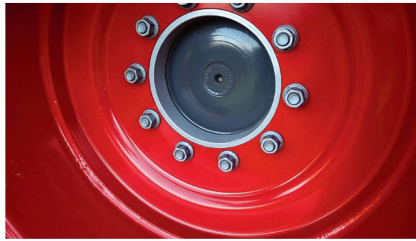
Mit einem Distanzring wurde die Achse so verbreitert, dass die Felge direkt nach der Kabinenfederung folgt.
