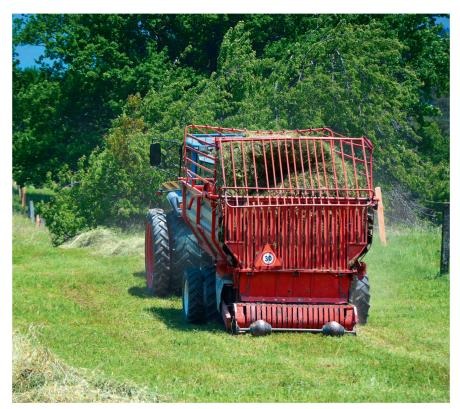
Das Gespann Traktor/Ladewagen wird erst mit der Triebachse richtig berggängig.
