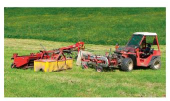
Zweiachsmäher sind eigentliche Geräteträger, entsprechend gross ist die Palette der Anbaugeräte.
