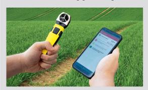
zeigt, ob das Streugut bei der vor Ort gemessenen Windgeschwindigkeit ausgebracht werden sollte. Dabei entscheidend ist die Windgeschwindigkeit quer zur Fahrtrichtung, da der Seitenwind die grösste Gefahr für die potenzielle Verwehung des Düngers darstellt.
