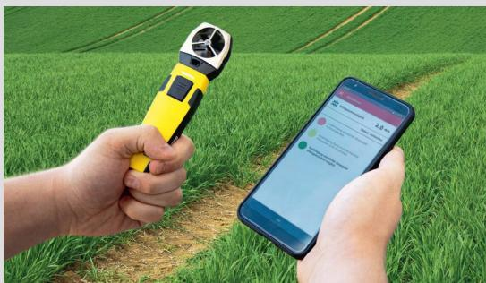
zeigt, ob das Streugut bei der vor Ort gemessenen Windgeschwindigkeit ausgebracht werden sollte. Dabei entscheidend ist die Windgeschwindigkeit quer zur Fahrtrichtung, da der Seitenwind die grösste Gefahr für die potenzielle Verwehung des Düngers darstellt.
