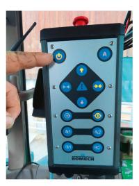
Mit der «i-Control»-Steuerung lässt sich der Verteiler über das Load-Sensing-System oder mit Konstant-Strom über ein einfachwirkendes Steuerventil mit drucklosem Rücklauf bedienen. Die Umschaltung erfolgt mit einem Handgriff.
