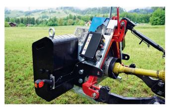
Die elektronische Ansteuerung ermöglicht am Drehregler eine anwenderfreundliche Verstellung der maximalen Bremsleistung.
