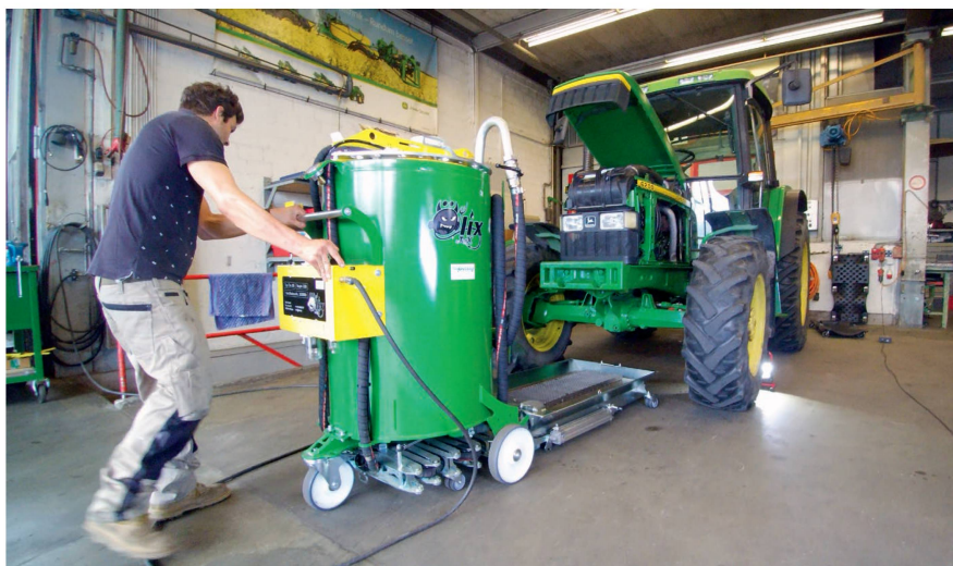
Der druckluftversorgte «Ölix» wird vor den Traktor gefahren, anschliessend kann die Wanne über die Schere (unterhalb Behälter) unter die Maschine geschoben werden. Bilder: R. Engeler
