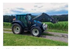
Fehlt die Fronthydraulik, ist auch ein fester Aufbau möglich, wie hier sogar in Kombination mit montiertem Frontlader.
