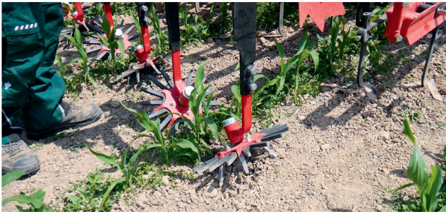
Die nachlaufenden Fingerhacken können nahe oder sogar zwischen die Reihen hacken.
