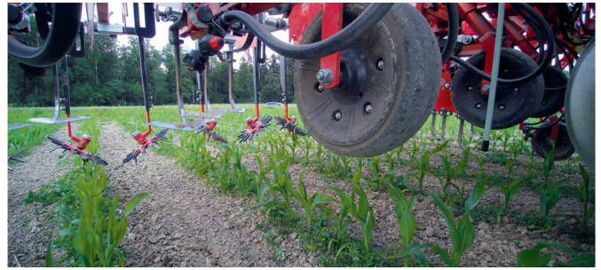
Dieses Gerät ist mit sogenannten Kombi-Hackelementen ausgerüstet, die an einem Vibro-Halter befestigt sind.
