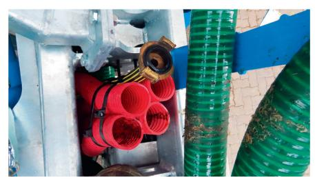
Über diese roten Schläuche bekommt der Verteilkopf Luft. Der schwarz-gelbe Schlauch dient für einen Wasseranschluss zum Spülen des Verteilkopfs.
