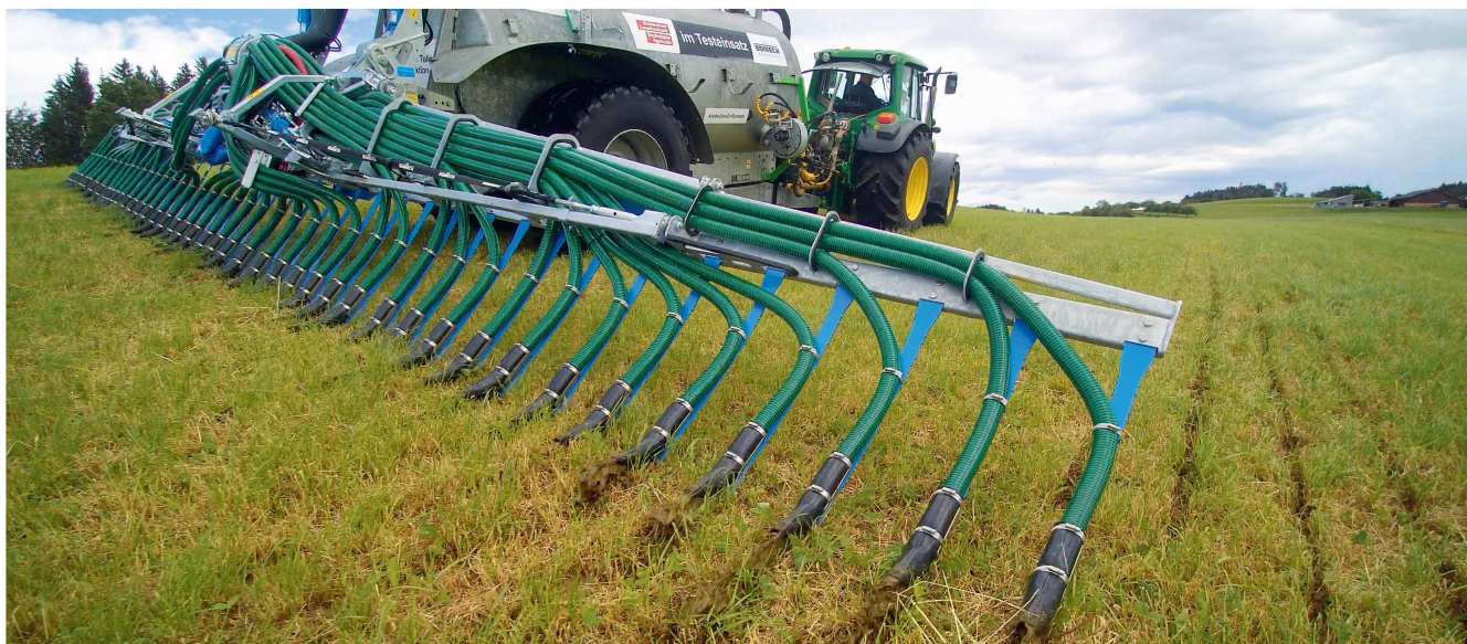
Der Bomech «Speedy One» mit 10,5 m Arbeitsbreite bietet praxisnahe Technik, grössere Unabhängigkeit von der Witterung und verringert die Emissionen. Bilder: M. Abderhalden und R. Engeler
