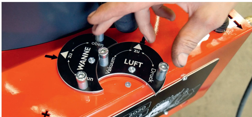
Drehschieber am Bedienpult für Einstellung von Druck oder Vakuum sowie der Absaugstelle.
