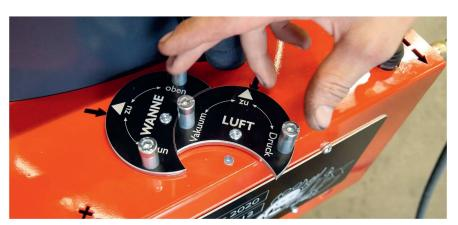
Drehschieber am Bedienpult für Einstellung von Druck oder Vakuum sowie der Absaugstelle.
