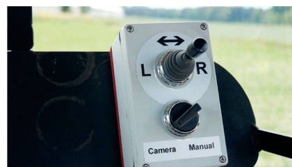
Die automatische Lenkung kann mit einem Hebel temporär übersteuert oder auch gänzlich ausgeschaltet werden.
