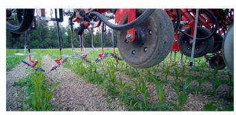
Dieses Gerät ist mit sogenannten Kombi-Hackelementen ausgerüstet, die an einem Vibro-Halter befestigt sind.
