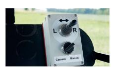
Die automatische Lenkung kann mit einem Hebel temporär übersteuert oder auch gänzlich ausgeschaltet werden.
