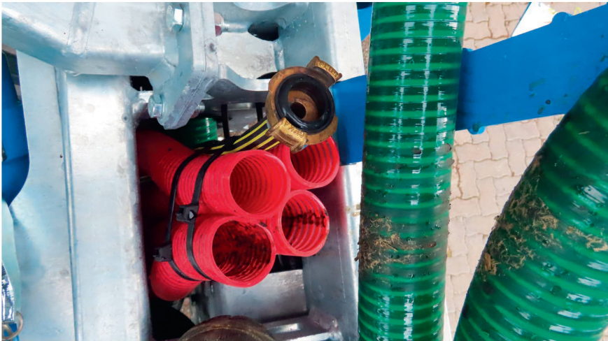
Über diese roten Schläuche bekommt der Verteilkopf Luft. Der schwarz-gelbe Schlauch dient für einen Wasseranschluss zum Spülen des Verteilkopfs.
