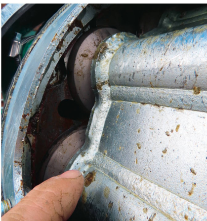
Die aussermittig gelagerten Messer drehen sich. Die zweischneidige Klinge schneidet vorne und reinigt hinten die Lochplatten.
