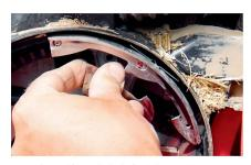
Der Abstreifer wird einfach ins Gehäuse geklemmt und muss in der Folge nicht mehr verstellt werden.
