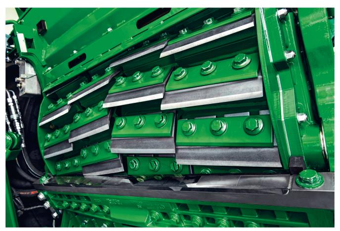
John Deere schärft die Messer schonend bei rückwärtsdrehender Trommel. Bild: John Deere
