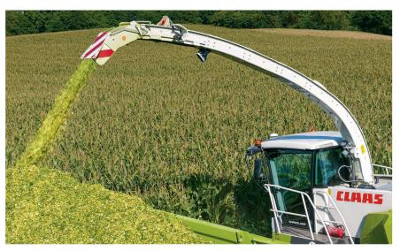
Gemäss eigenen Angaben werden bei Claas rund 25% der verkauften Feldhäcksler mit «Shredlage»-Crackern ausgeliefert.
