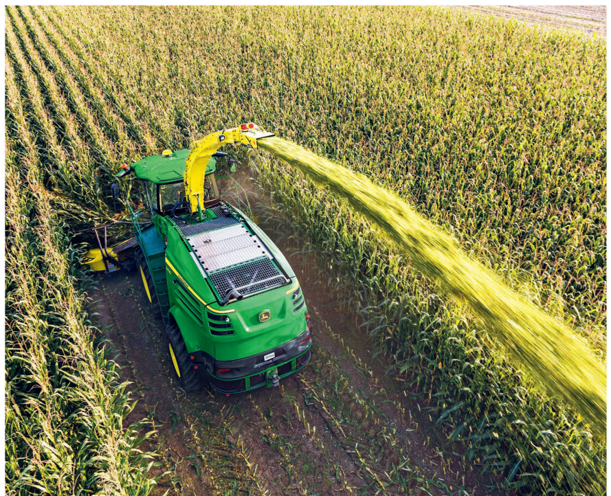
Die Wurffleistung ist das Ergebnis des dafür auf Leistung getrimmten Wurfbeschleunigers.
