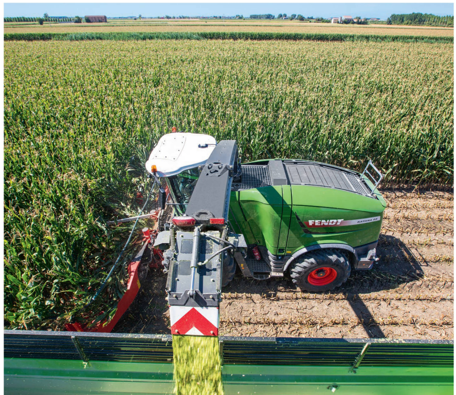
Dank einer Grenzlastregelung wird die Fahrgeschwindigkeit automatisch der Erntemasse angepasst. Bild: Fendt
