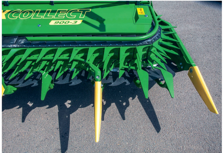
Der etwas andere Maisvorsatz von Krone hat umlaufende Ketten-Kollektoren. Bild: Krone
