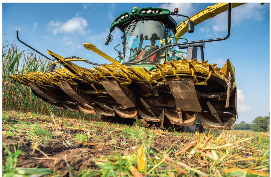
Mit dem «StalkBuster» von Kemper wird versucht, die Maisstoppel möglichst zu zerstören.
