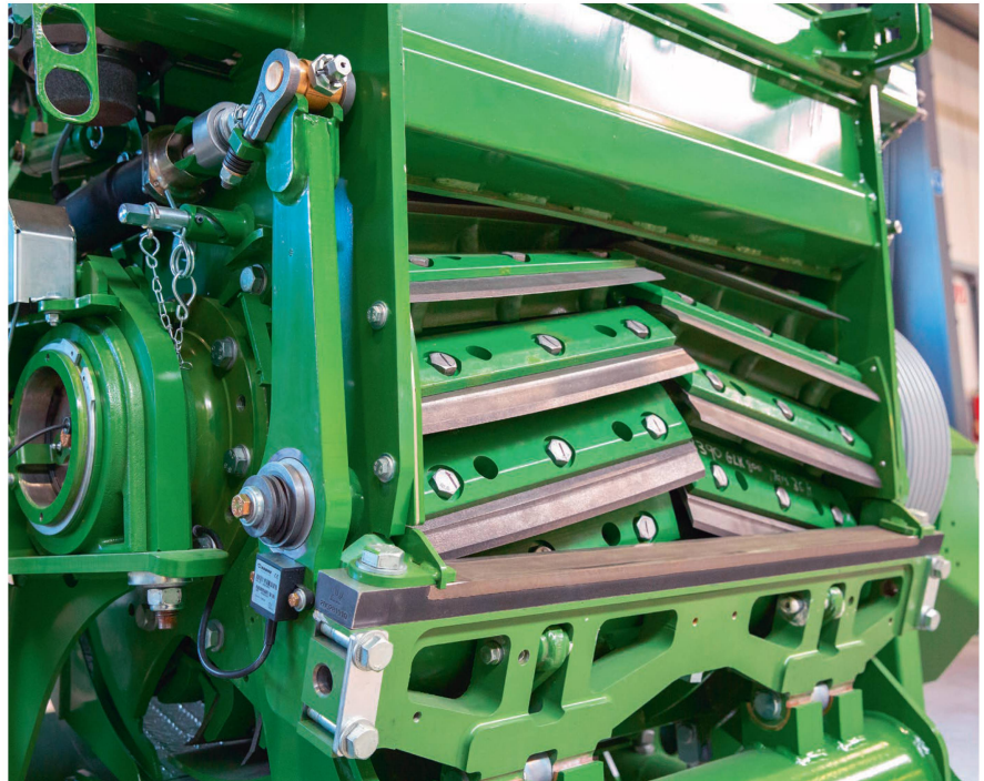
Die V-förmige Anordnung der Messer auf der Schneidtrommel dominiert heute. Bild: Krone
