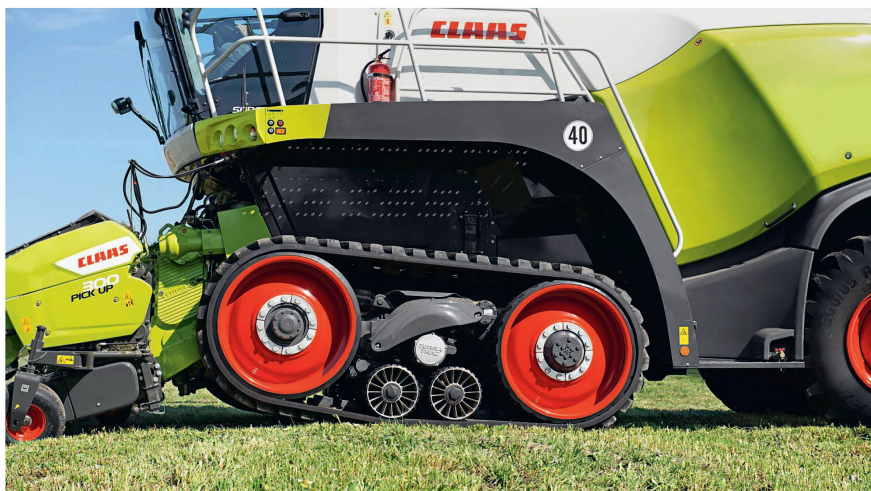
Beim «TerraTrac»-Laufwerk werden beim Wendevorgang die mittleren Rollen hydraulisch nach unten gedrückt. Bild: Claas
