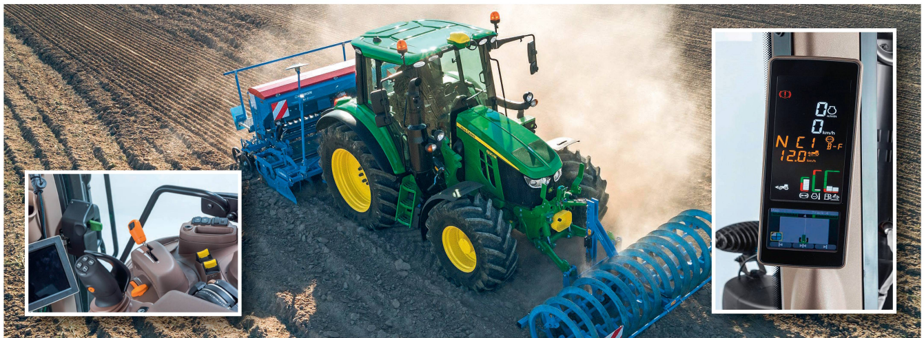
Die John-Deere-«6M»-Baureihe ist neu mit dem stufenlosen «AutoPowr»-Getriebe erhältlich. Die Lenkautomatik «AutoTrac» wird nun auch im Eckpfostendisplay (kleines Bild rechts) angezeigt. Bilder: zvg
