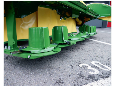
Die äusseren beiden Mähtrommeln mit zwei und vier Schlagleisten sollen für einen sicheren Gutfluss sorgen.
