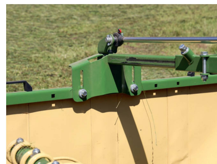
Optional kann das Schwadtuch hydraulisch verstellt und geklappt werden.
