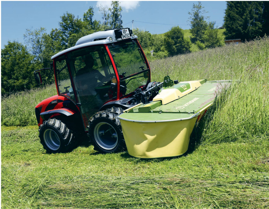
Die zwei «Highland»-Mähwerke – hier das «EasyCut F 280» – können ohne Weiste-Dreieck direkt und nah am Trägerfahrzeug angebaut werden, was das Gewicht kompensiert.
