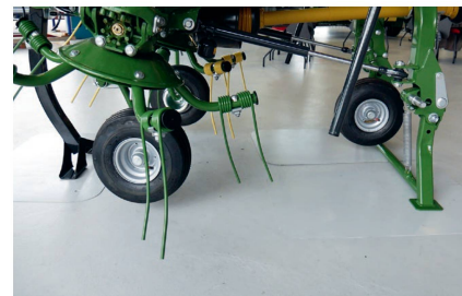
Die Kreiselheuer können freitragend, auf einer Doppelstütze vorne und einer Stütze hinten, abgestellt werden.
