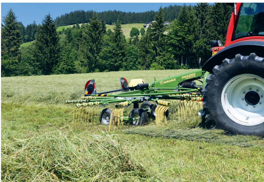
Die alpinen Schwader basieren auf dem Konzept der «Swadro», sind aber leichter und niedriger gebaut.
