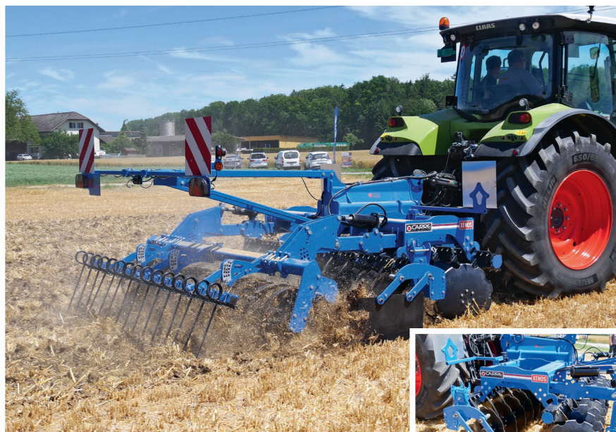
Die 3-m-Scheibenegge «Xenos» mit 22 gezackten Hohl-scheiben, hier im Einsatz mit Packerwalze und einreihiger Kammegge.
