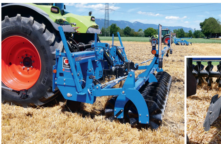
Tiefenlockerer «Neolab Eco» mit sechs «Michel 800»-Scharen und Kategorie-3-Hubwerk. Eine Verschleiss-Platte auf dem Scharträger hebt den Boden noch vor der Klinge an.
