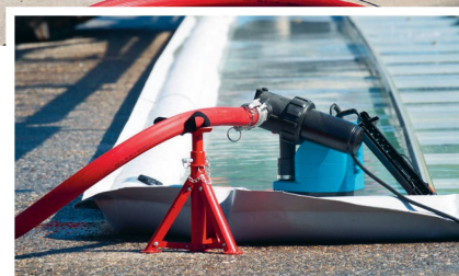
Mit einer Wasserpumpe wird die Spritzbrühe wieder zurück in die Spritze oder an einen dafür bestimmten Ort gepumpt.
