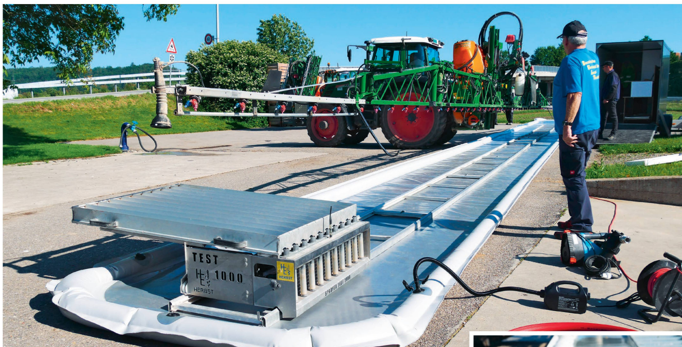
Die neue Auffangwanne mit aufblasbaren Seitenwänden im ersten Einsatz. Bilder: H. Röthlisberger
