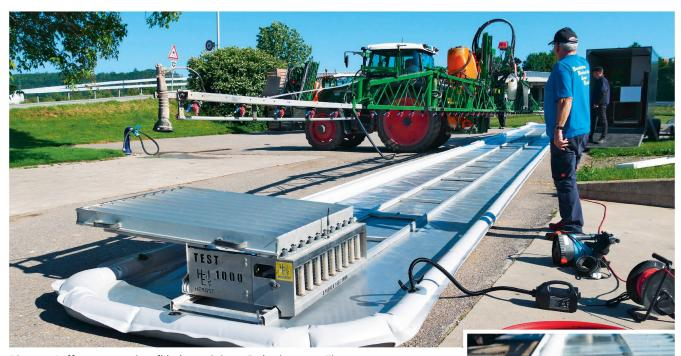
Die neue Auffangwanne mit aufblasbaren Seitenwänden im ersten Einsatz. Bilder: H. Röthlisberger
