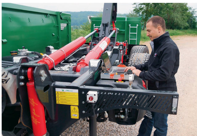
Jean-Philippe Mergel beim Programmieren der Elektronik an einem Hakengerät mit zwei gelenkten Achsen.
