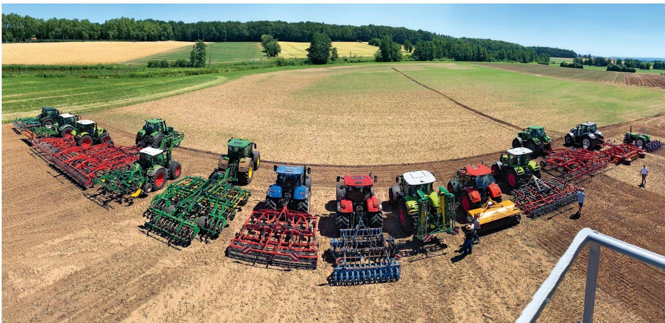
Insgesamt nahmen 13 ausgewählte Maschinen am Versuch teil, mit dem die Wirkung mechanischer Massnahmen zur Bekämpfung von Ausfallgetreide und Unkräutern vor der Saat untersucht wurde. Bilder: BZ Triesdorf
