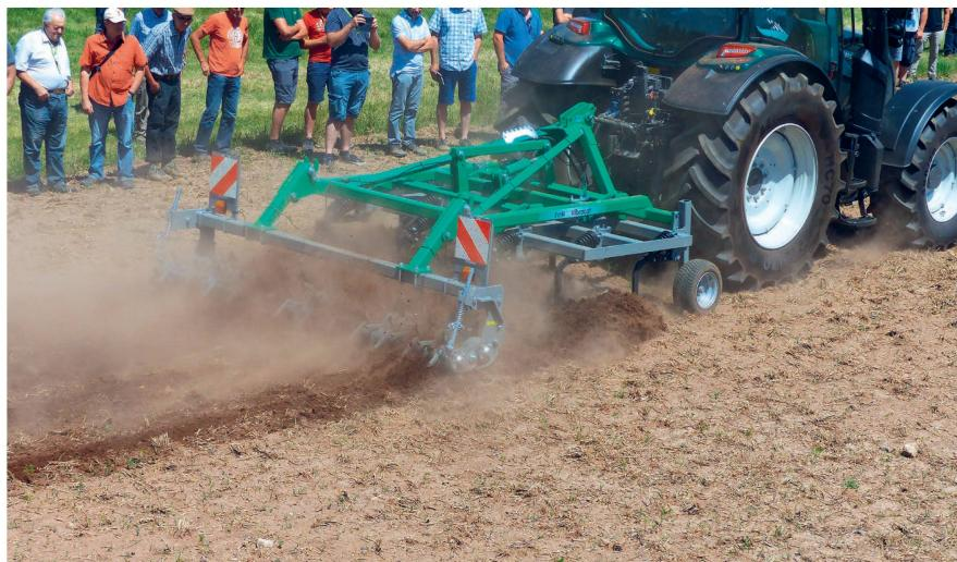
**Positiv für kleinere Betriebe ist, dass gute Ergebnisse mit einem dreibalkigen Standardgrubber in Verbindung mit breiten Scharen und Striegeln erzielt wurden.**
