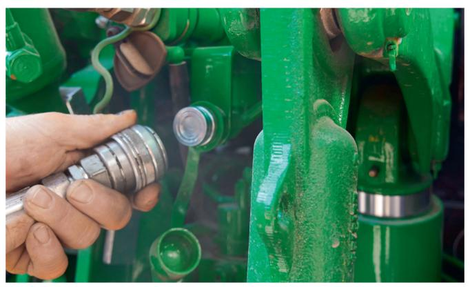
Ab sofort, aber nur bis Ende 2025 und mit gewissen Vorgaben erlaubt: das Ankoppeln eines Anhängers mit H2L-Bremssystem an einen Traktor mit H1L-Bremsanlage. Bilder: R. Engeler
